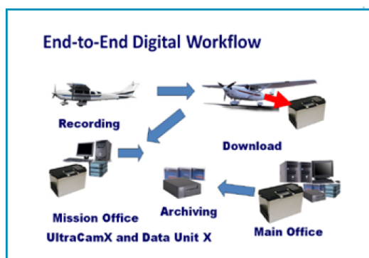
Εικόνα 2-6 :Το επανατροφοδοτούμενο σύστημα αποθήκευσης της Ultracam - Xp
