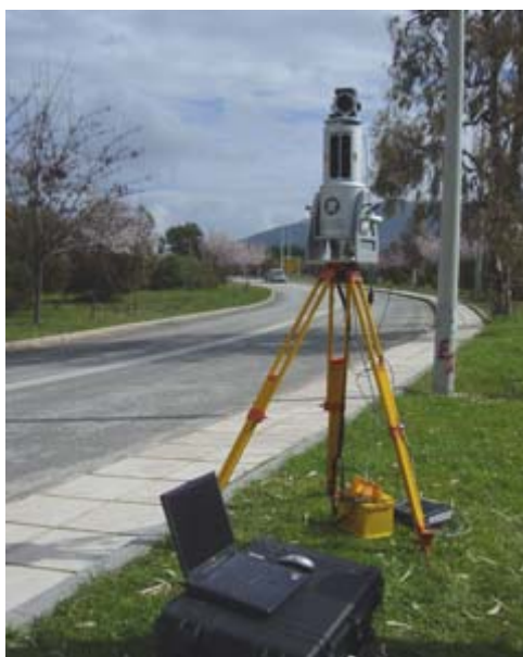
Εικόνα 12. Επίγειος Σαρωτής Laser Riegl LMS-Z360.
