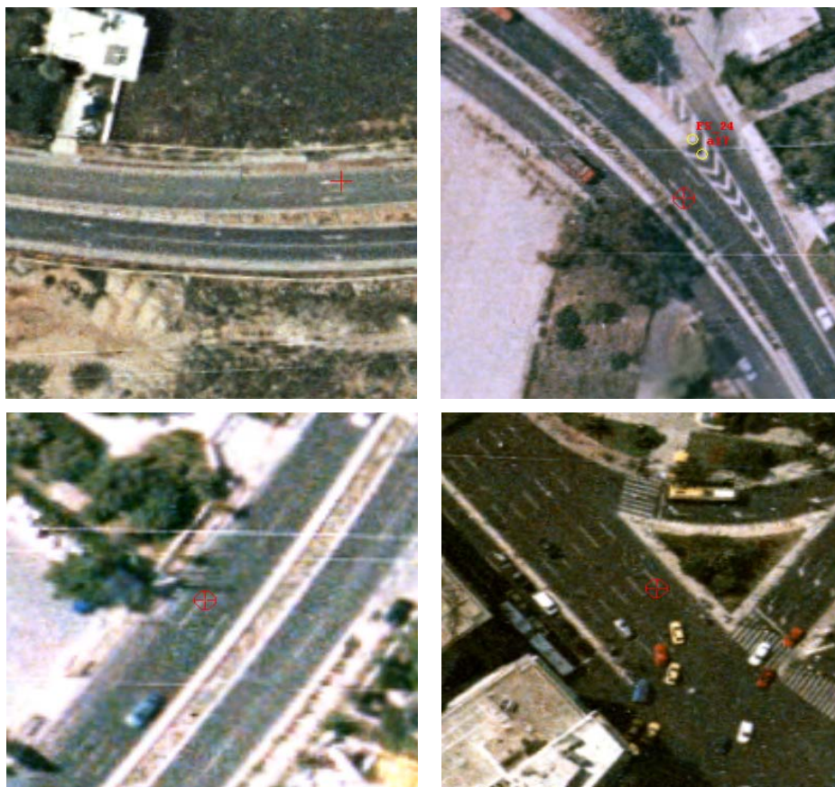
Εικόνα 39. Τέσσερα σημεία που στοχεύθηκαν 20 φορές το καθένα για τον προσδιορισμό της ακρίβειας απόδοσης της φωτογραμμετρικής διαδικασίας.
