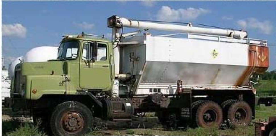
Εικόνα 1.11: Φορητό όχημα δημιουργίας και μεταφοράς του ANFO.
