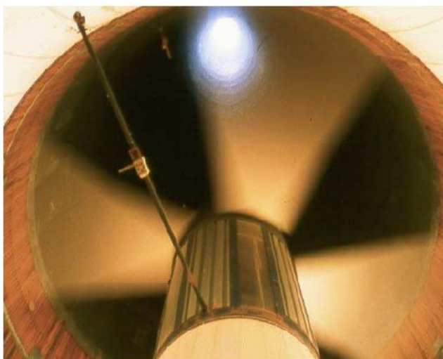
Σχήμα Γ.10.3. Στρόβιλος πρωτότυπης μονάδας
