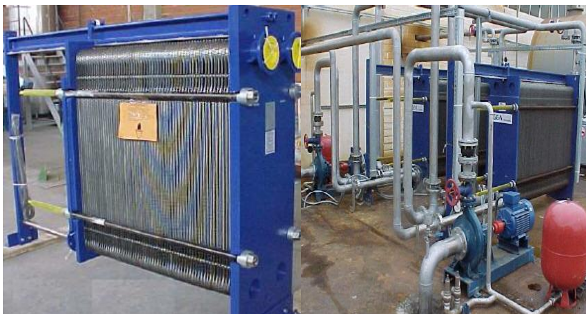
Σχήμα 23 Εναλλάκτης πλακών σε εφαρμογή ανάκτησης θερμότητας από υγρά απόβλητα.
