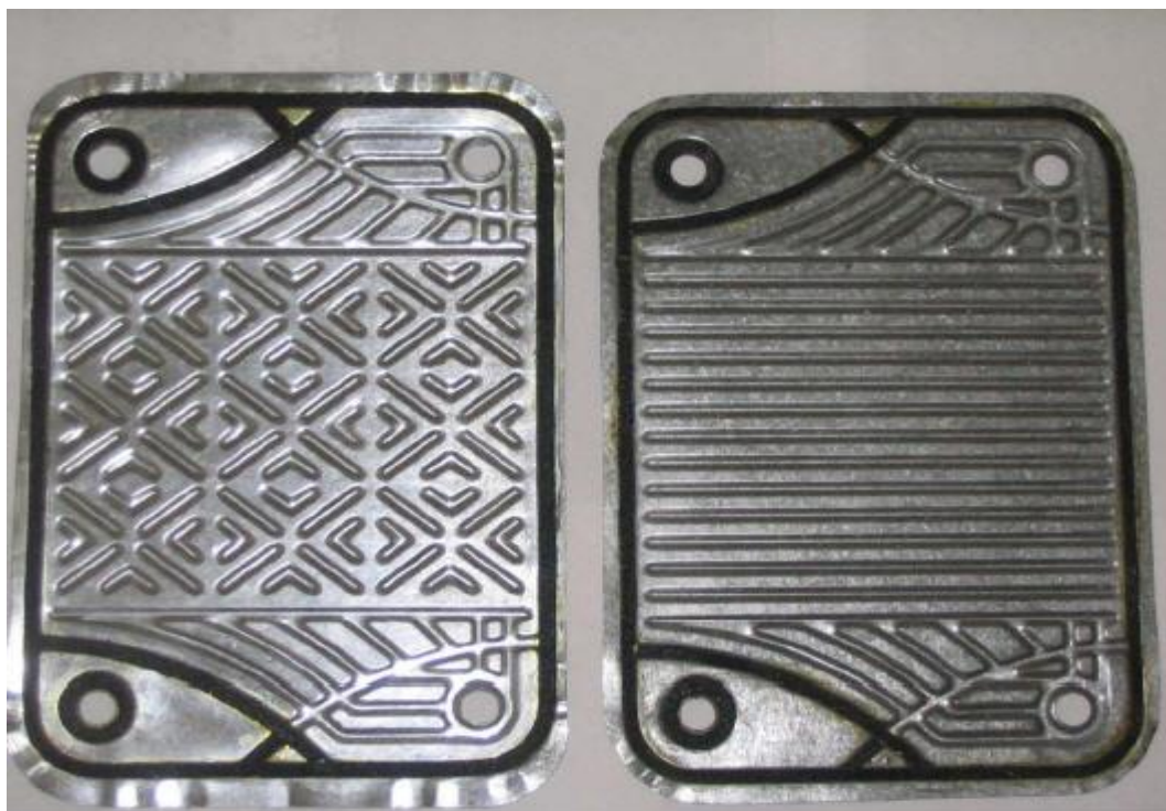
Σχήμα 38 Πλάκες εναλλάκτη θερμότητας με αστερίσκους και οριζόντιες αυλακώσεις .
