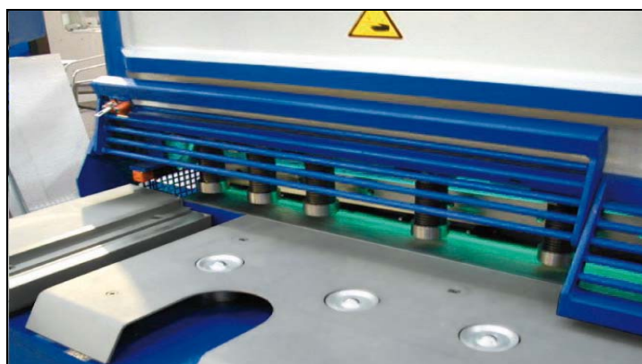
Εικόνα 1.2: Εμπρόσθιος ανοιγόμενος προφυλακτήρας με διακόπτη ασφαλείας
