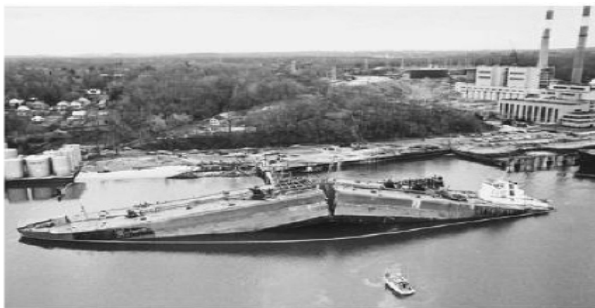
Εικόνα 1.1-Αστοχία τύπου jack-knifed πλοίου τ. Liberty
