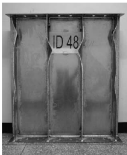
Σχήμα 1.26-Αστοχία 'tripping' του ενισχυτικού
