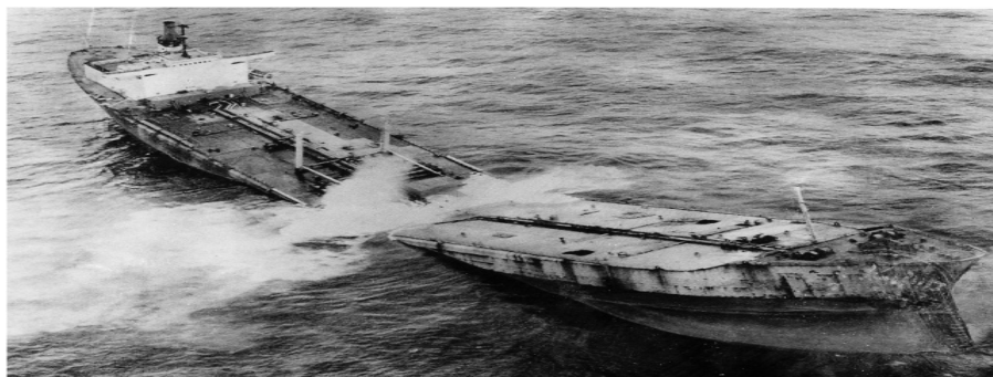
Εικόνα 1.2-Αστοχία διαμηκών δομικών στοιχείων
