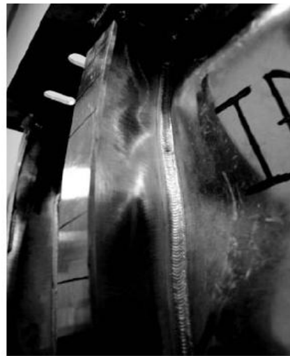
Σχήμα 1.25-Τοπική κατάρρευση κορμού του ενισχυτικού
