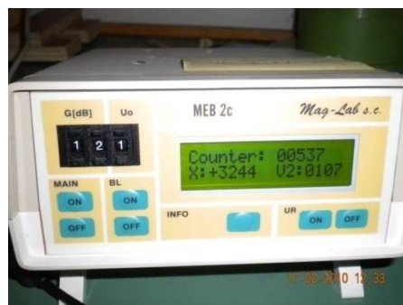
Σχήμα 3.2 :Κεντρική μονάδα τροφοδοσίας σήματος και επεξεργασίας δεδομένων
