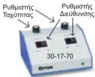
Εικόνα 3.17: Ρυθμιστές ταχύτητας και διεύθυνσης κινητήρων μικροσκοπίου.
