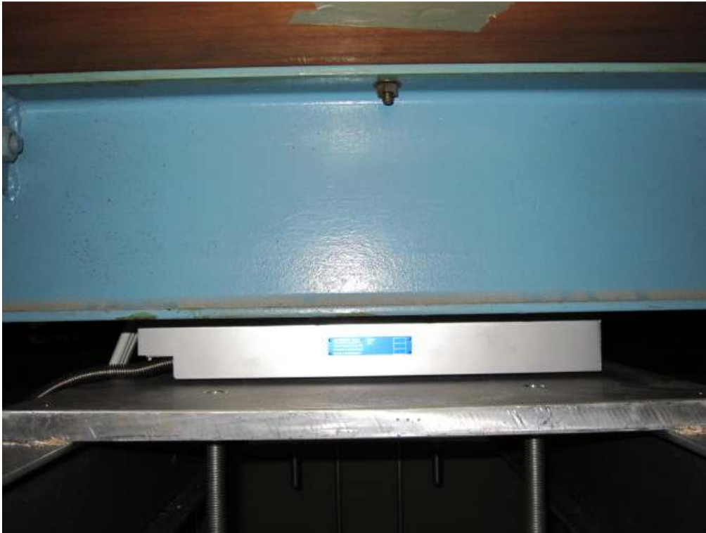
2.4.1.6 Φωτογραφία όπου φαίνεται ο ζυγός μέτρησης τριών δυνάμεων τριών ροπών του εργαστηρίου αεροδυναμικής Photo where we can see the multi-component force plate
