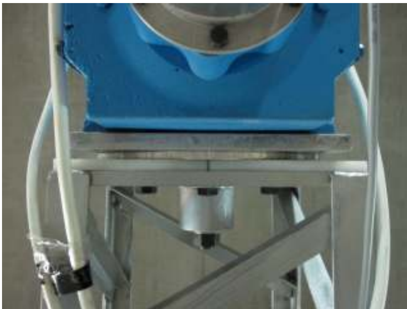
2.4.1.7 Φωτογραφία όπου φαίνεται ο δίσκος περιστροφής και βαθμονόμησης της γωνίας yaw, καθώς και οι κοχλίες σταθεροποίησης της θέσης γωνίας yaw Photo where we can see the rotation and calibration disc of the yaw angle, and the screws that stabilise the position of yaw angle
