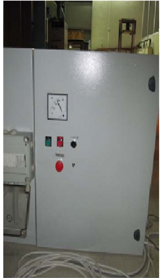
2.4.3.3 Ο πίνακας ελέγχου του κινητήρα όπου φαίνονται οι συνδέσεις από όπου παίρναμε το σήμα του ρεύματος και της τάσης του κινητήρα, της τάσης της διέγερσης καθώς και της τάσης της ταχογεννήτριας για την μέτρηση της ταχύτητας περιστροφής του δρομέα The motor control box whence we were getting the signal of the current and the voltage of the DC motor, the excitation voltage and the voltage of the tachogenerator for the measurement of the rotor rotational speed
