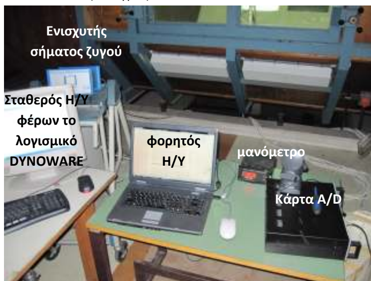
4.1.1 Σχήμα διάταξης των μηχανημάτων λήψης των μετρήσεων Photo of the signal obtaining instrumentation arrangement
