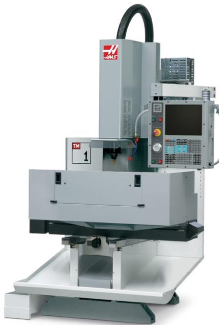
Εικόνα 6.0: Το κέντρο κατεργασιών CNC στο οποίο έγιναν οι μετρήσεις
