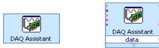
Εικόνα 5.17: Συσκευή DAQ πριν (αριστερά) και μετά (δεξιά) τις ρυθμίσεις του.
