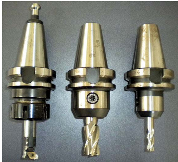
Εικόνα 6.1: Κοπτικά εργαλεία. Κοπτικό εργαλείο για boring με d=16\text{mm} (αριστερά), κοπτικό εργαλείο με d=20\text{mm} (κέντρο) και d=10\text{mm} (δεξιά).
