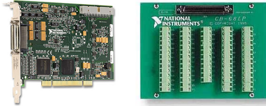
Εικόνα 5.7: Κάρτα Η/Υ λήψης δεδομένων (αριστερά) και πλακίδιο σύνδεσης μετρητικών οργάνων με την κάρτα καταγραφής (δεξιά).
