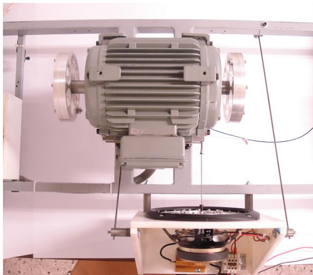
Σχήμα 1.4: Κάτοψη της εγκατάστασης με τον επενεργητή
