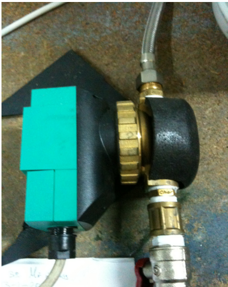
Σχήμα 42,43:Κυκλοφορητής της πειραματικής διάταξης ,Στοιχεία του κυκλοφορητή όπως φαίνονται πάνω σε αυτόν
