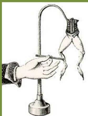
Εικόνα 1.1: Το πείραμα του Galvani. Όταν ο Γκαλβάνι ακουμπούσε τη σιδερένια ράβδο στο νεύρο του αντίστοιχου μυ, αυτός έκανε μία σύσπαση.
