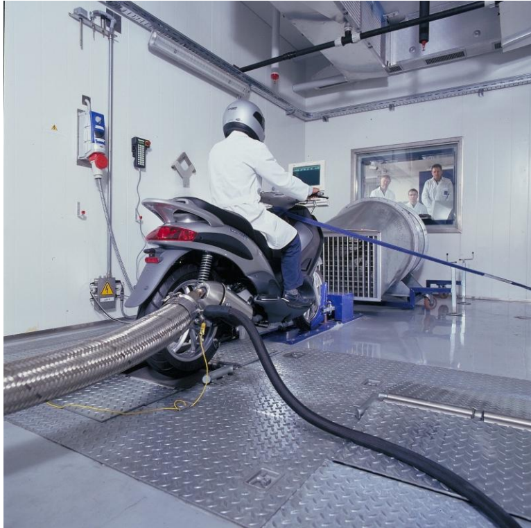
Σχήμα 3.3: Δοκιμή Ελέγχου Εκπομπών σε scooter (European Commission 2009)
