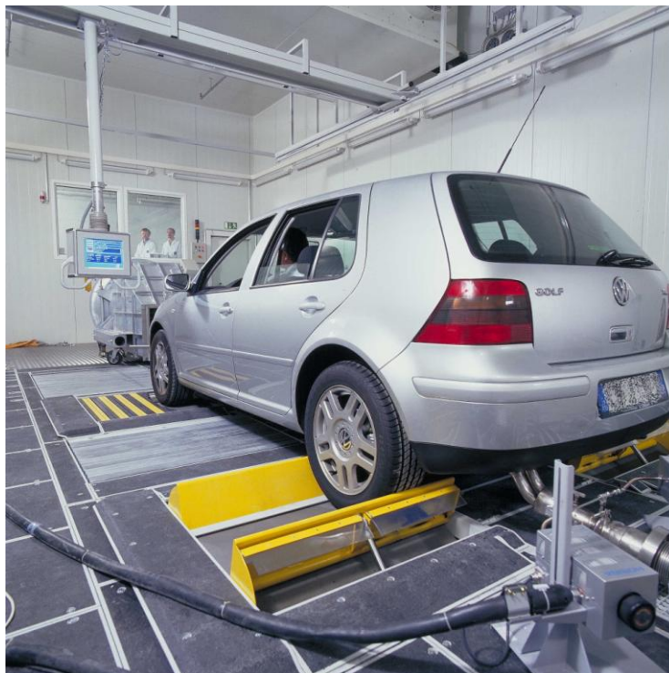
Σχήμα 3.2: Επιβατικό όχημα σε εγκατάσταση Κύκλου δοκιμής για έλεγχο εκπομπών (European Commission 2009)
