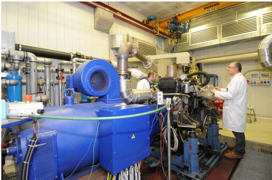
Σχήμα 3.5: Κινητήρας βαρέος τύπου στη θέση του δυναμόμετρου δοκιμής κινητήρων κατά τον έλεγχο εκπομπών (European Commission 2009).
