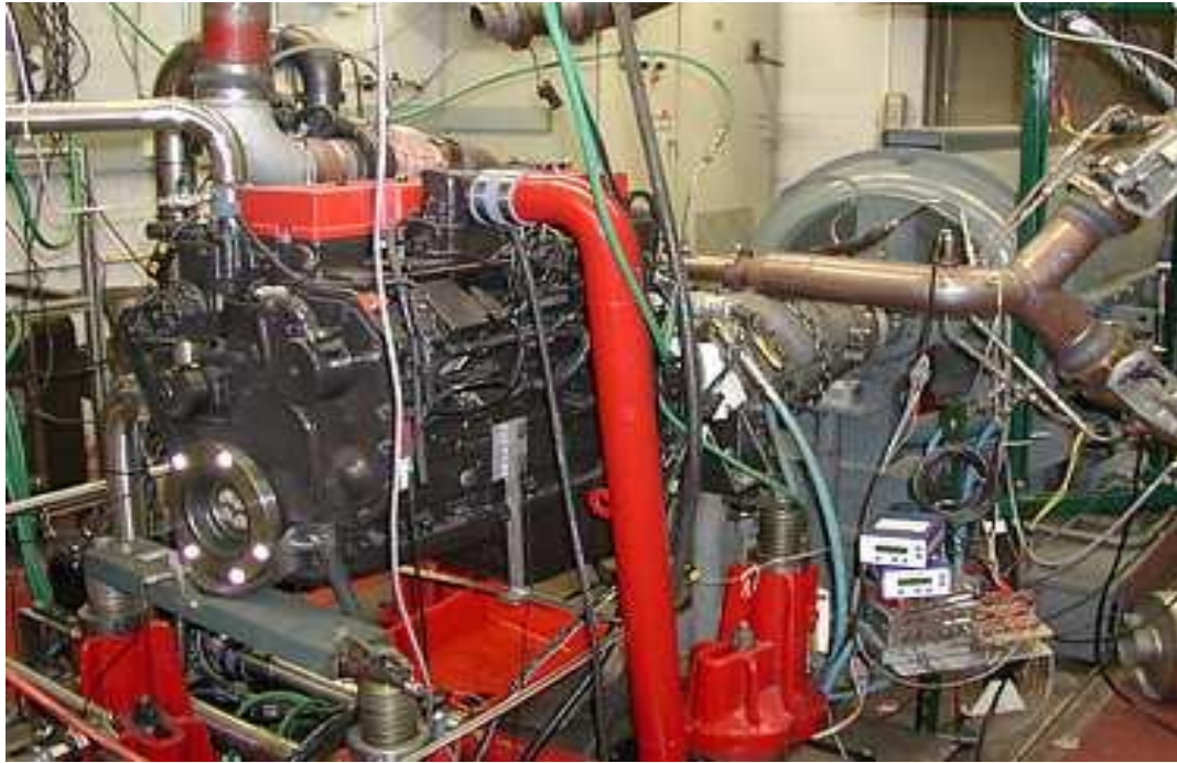
Σχήμα 3.4: Κινητήρας βαρέος τύπου στη θέση του δυναμόμετρου δοκιμής κινητήρων.
