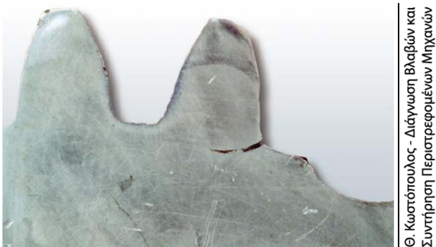
Εικόνα 3.3.2-2: Σπασμένος οδόντας στα δεξιά και έναρξη ρωγμής στα αριστερά της εικόνας.
