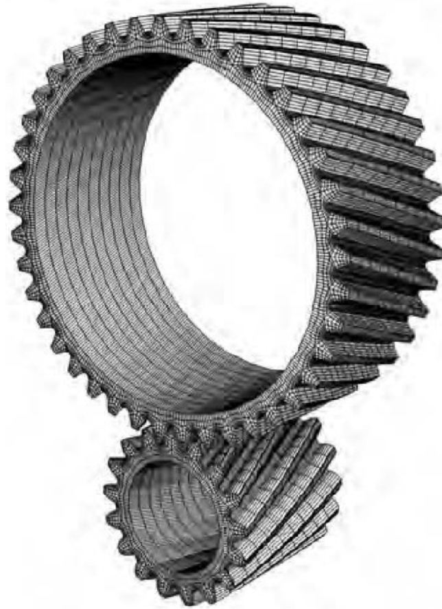
Εικόνα 5.2-1: Μοντέλο πεπερασμένων στοιχείων βαθμίδας εξωτερικών οδοντωτών τροχών (ελικοειδείς τροχοί).
