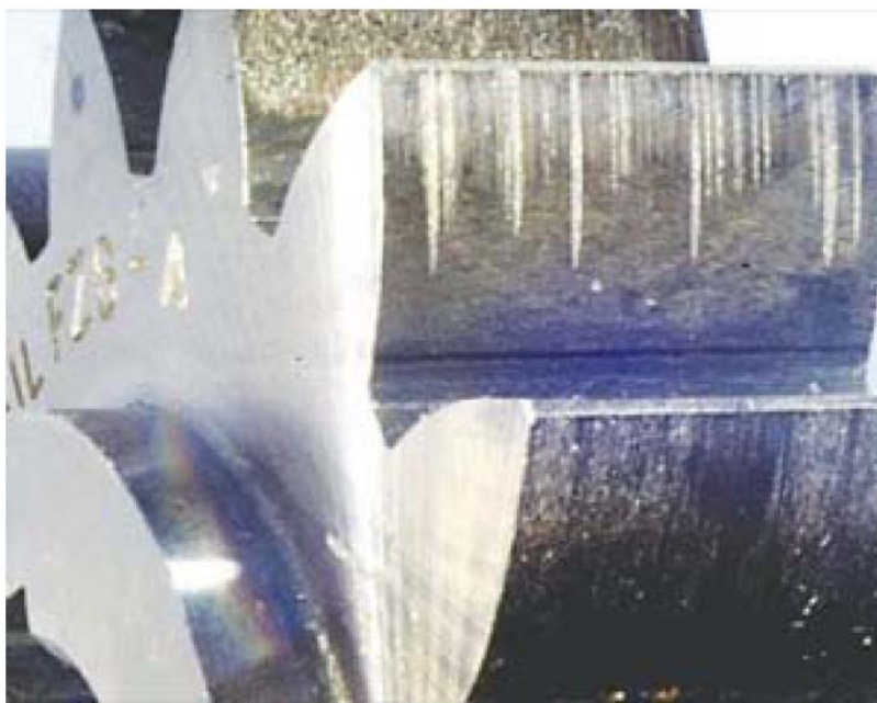
Εικόνα 3.3.3-1: Οδοντωτός τροχός που έχει φθαρεί λόγω χάραξης της επιφάνειάς του.
