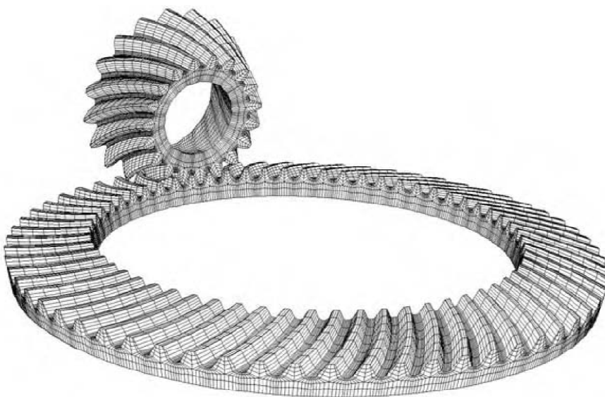
Εικόνα 5.2-2: Βαθμίδα κωνικών οδοντωτών τροχών με ελικοειδείς οδόντες.
