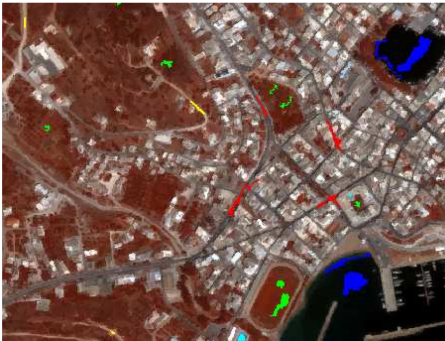
Εικόνα 3: Δείγματα που καθορίζονται από το χρήστη για ταξινόμηση με χρήση του εγγύτερου γείτονα
