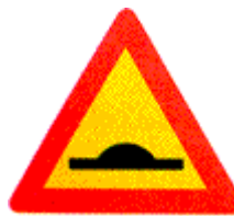
Εικόνα 44, Κ-10, Επικίνδυνο υπερυψωμένο οδόστρωμα ή απότομη κυρτή αλλαγή της κατά μήκος κλίσης της οδού
