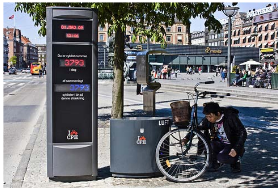
Εικόνα 27, Bicycle Counters, Μετρητές ποδηλάτων στην πόλη της Κοπεγχάγης, που στόχο έχουν την παρακολούθηση της ροής του ποδηλατικού δικτύου της πόλης
