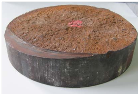
Φωτογραφία 6.1 Ακατέργαστο αρχικό κομμάτι χυτοσιδήρου.
