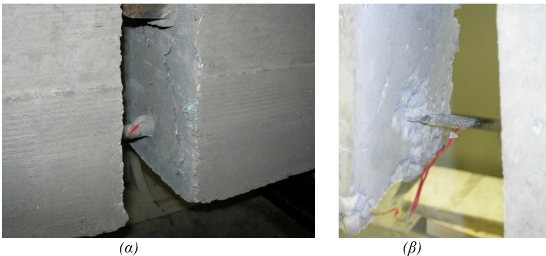
Σχήμα 4.5 : Αστοχία δοκών μετά την διεξαγωγή των πειραμάτων: (α) με την ράβδο GFRP, (β) με την ράβδο CFRP.
