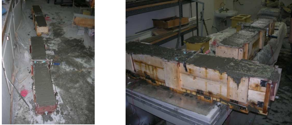
Σχήμα 4.3 : Οι πειραματικές δοκοί σε ξύλινα καλούπια
