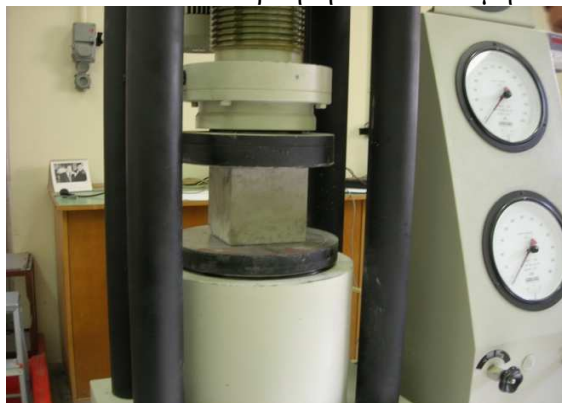
Σχήμα 4.2 : Η δοκιμή θλίψης των κυβικών δοκιμών.
