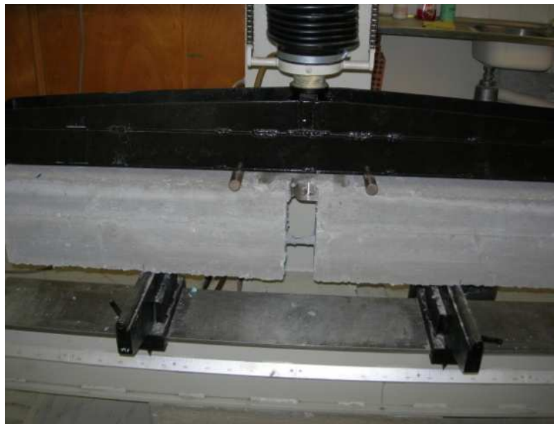
Σχήμα 4.4 : Πειραματική δοκός στην μηχανή κάμψης.
