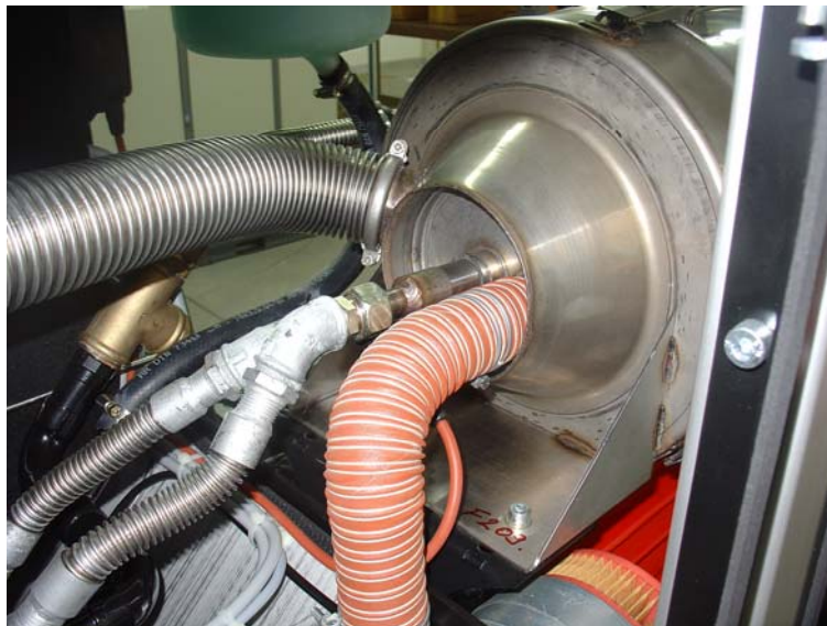
Σχήμα 5.6: Προθερμαντήρας αέρα (κόκκινος σωλήνας παροχής αέρα καύσης, μεταλικός αγωγός απαγωγής καυσαερίων και δύο μικρής διαμέτρου μεταλικοί αγωγοί παροχής καύσιμου).
