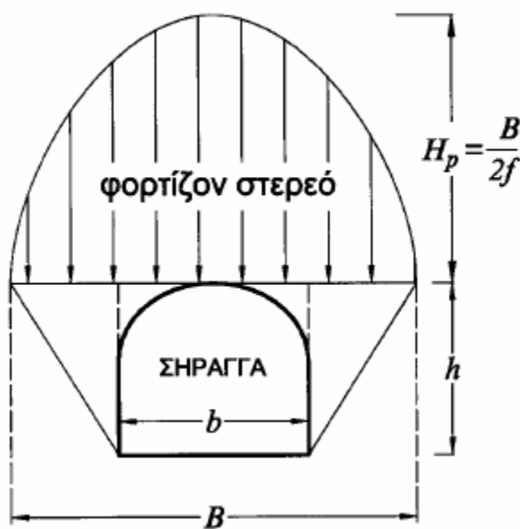
Σχήμα 3-2: Εκτίμηση φορτίων στην επένδυση της σήραγγας κατά τη μέθοδο Protodyakonov
