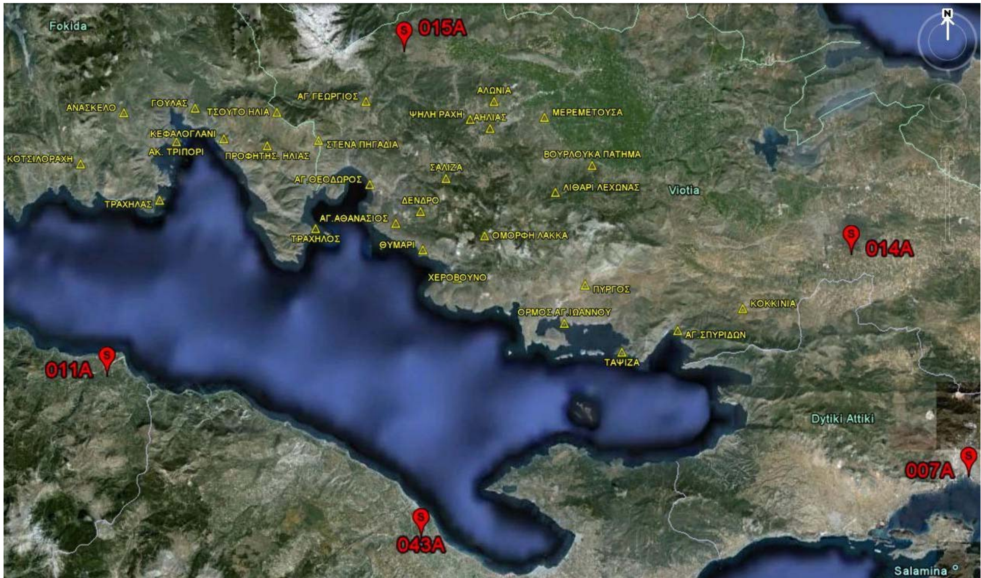
Φωτογραφία 3.3 Η θέση των 5 σταθμών αναφοράς του ΗΕΡΟS που χρησιμοποιήθηκαν για την επίλυση των βάσεων.
