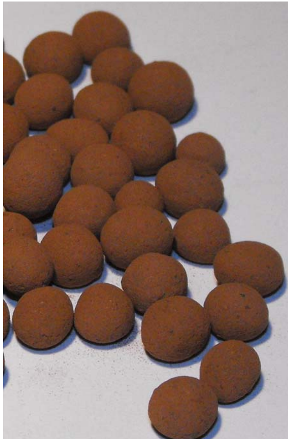
Σχήμα 7.4: Δείγμα σφαιρωμάτων (pellets) Ελληνικού νικελιούχου λατερίτη (MEE1) διαμέτρου -9,5+6,3 mm
