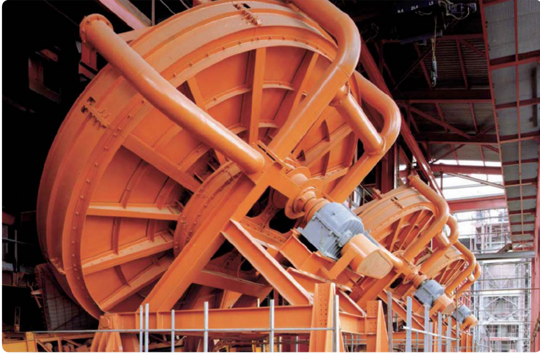
Σχήμα 7.2: Βιομηχανικοί δίσκοι συσφαιρώσεως στη σιδηρομεταλλουργία (Outokumpu Technology, 2005)
