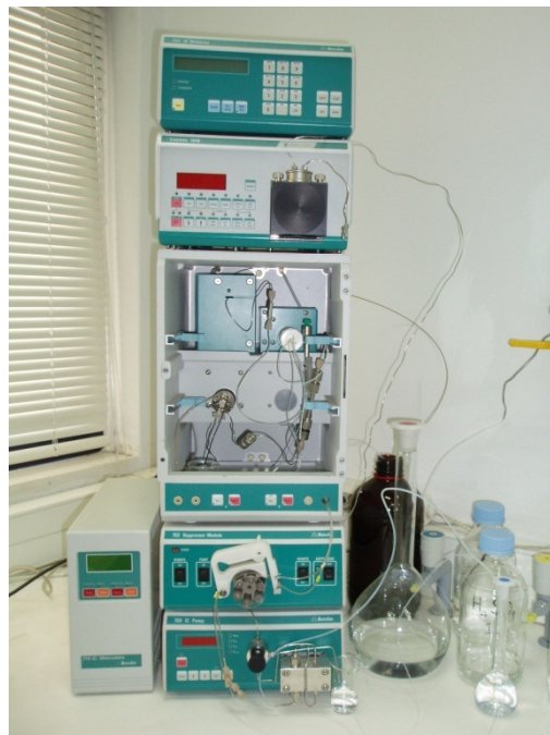
Εικόνα 13. Η διάταξη της μεθόδου της ιοντικής χρωματογραφίας.
