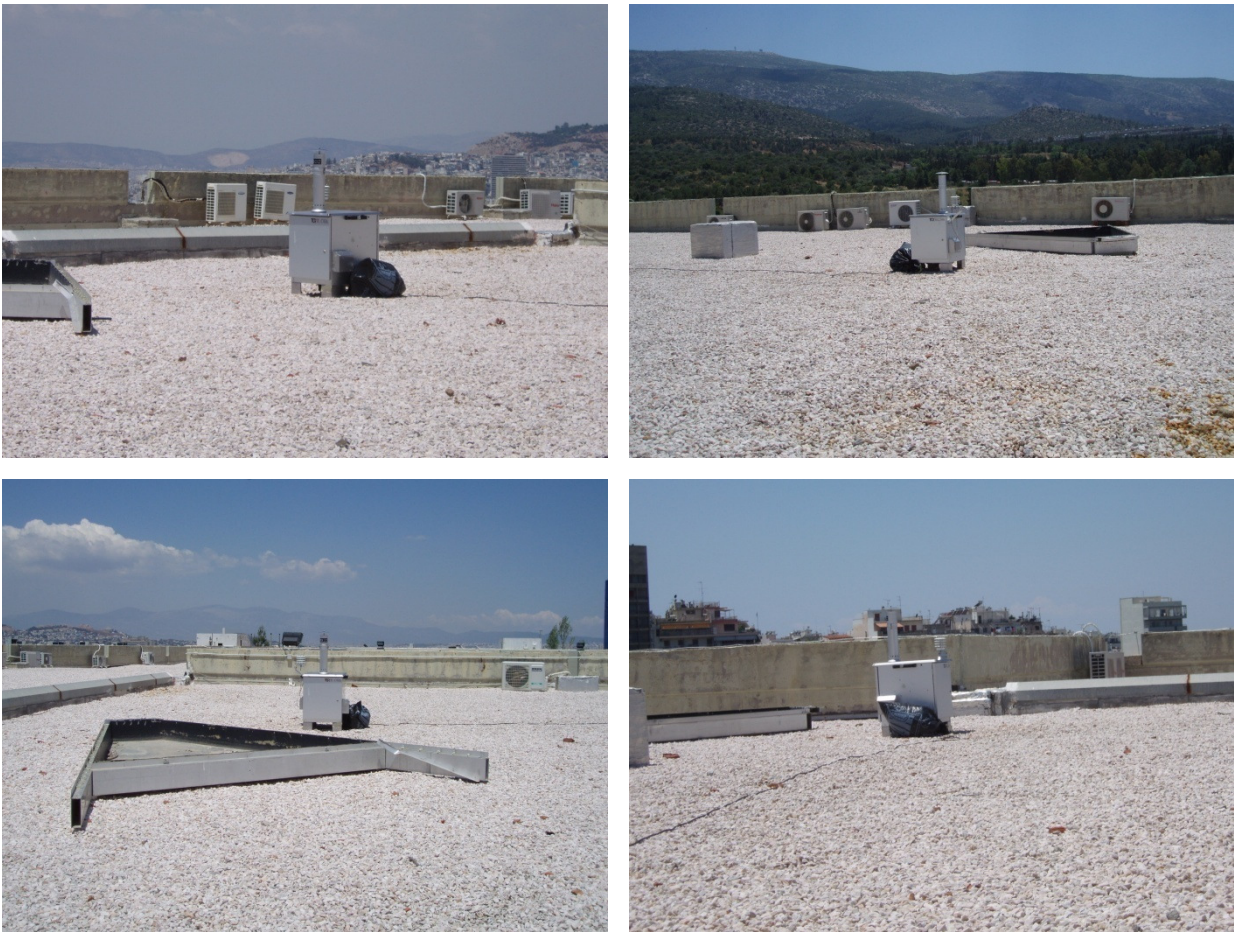
Εικόνα 8. Σημείο τοποθέτησης της συσκευής TCR Tecora και Dust Trak, στην ταράτσα του κτηρίου της σχολής Μηχανικών Μεταλλείων Μεταλλουργών στο Ε. Μ. Πολυτεχνείο.
