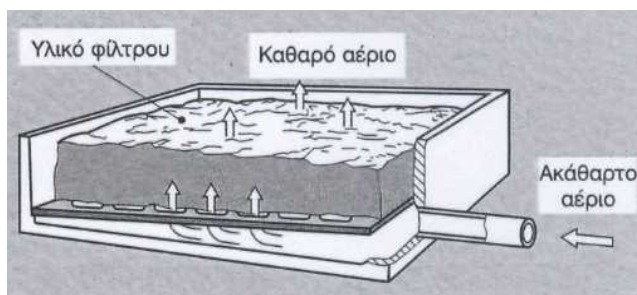
Εικόνα 6. Σχέδιο βιολογικού φίλτρου
