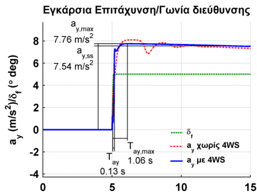
Σχ. 7.5 - Δοκιμή διέγερσης βαθμίδος οχήματος με 4WS με εύρος διέγερσης \delta_f = 5^{\circ}
