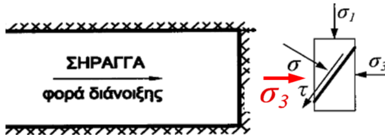
Σχήμα 4.6: Εντατική κατάσταση στο μέτωπο εκσκαφής της σήραγγας (Καββαδάς, 2007).
