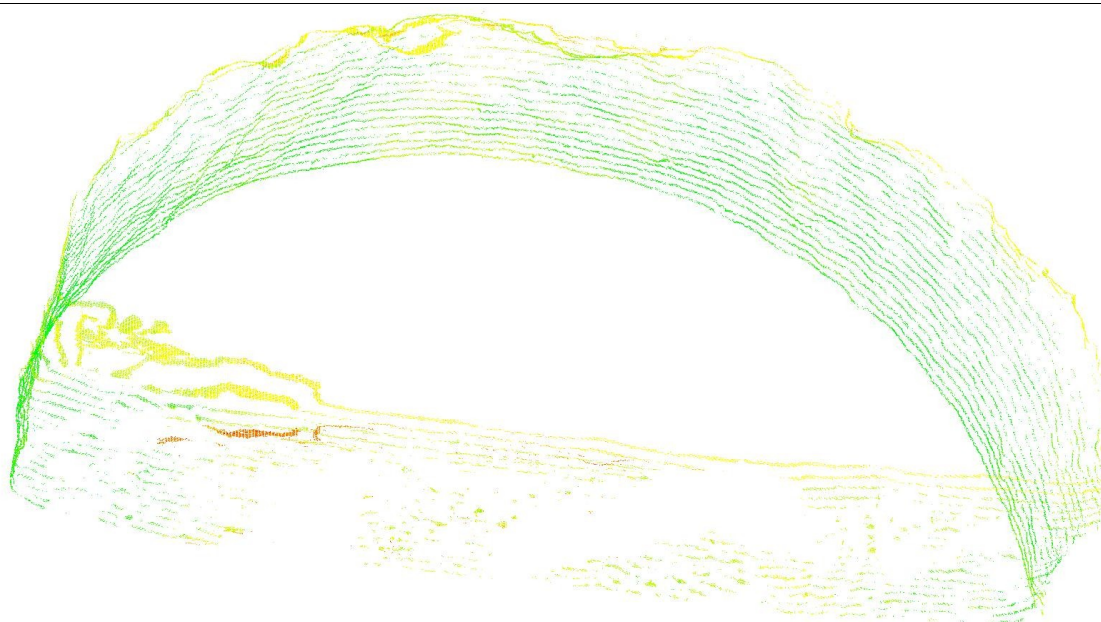
Σχήμα 7.4: Οι 19 διατομές από τη δεύτερη καταγραφή σε όψη προς το μέτωπο της σήραγγας
