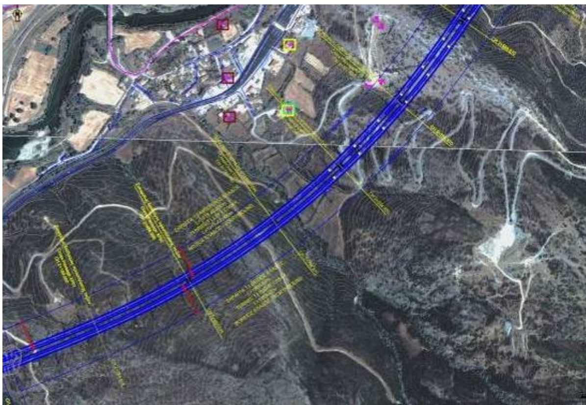
Σχήμα 4.4: Οριζοντιογραφία σήραγγας T1 Τεμπών (αεροφωτογραφία)
