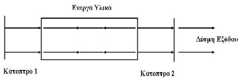
Σχήμα 3.1: Διάταξη ενός laser
