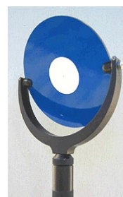
Σχήμα 5.8: Ειδικός στόχος σάρωσης
