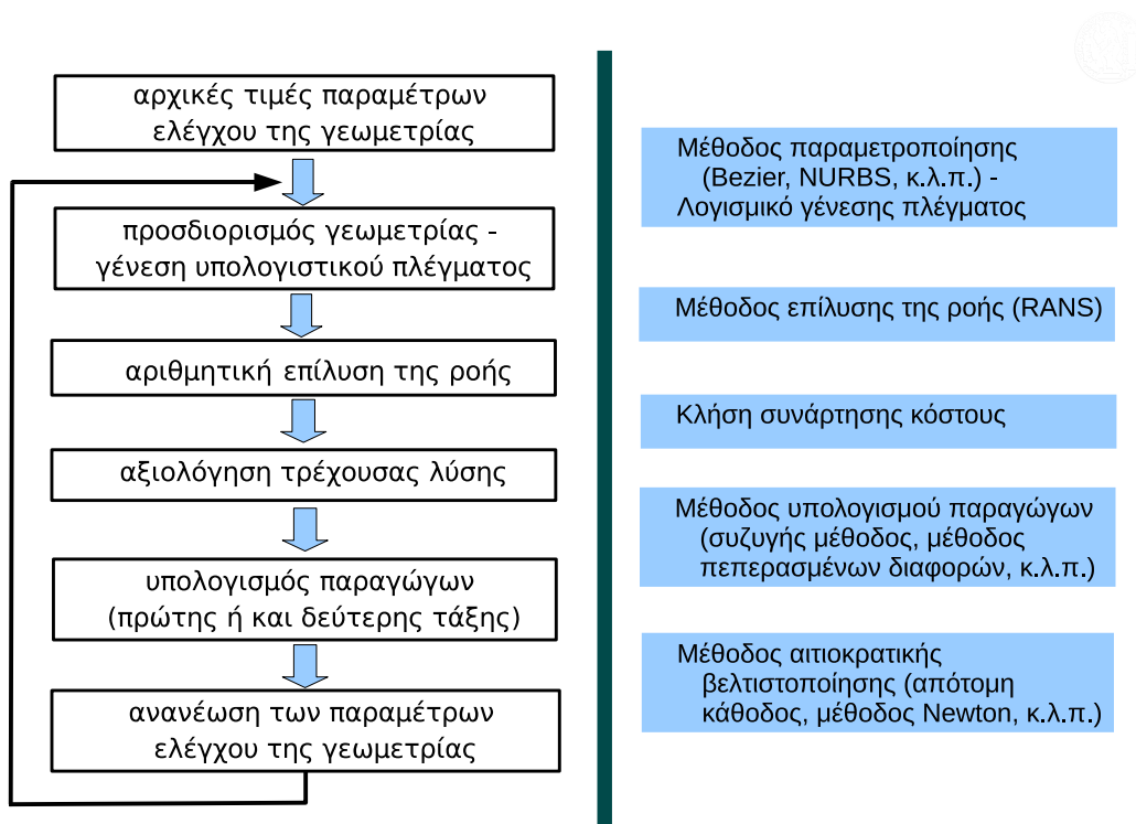
Σχήμα 1.1: Αιτιοκρατικός αλγόριθμος βελτιστοποίησης για προβλήματα ΥΡΑ. Ο αλγόριθμος επαναλαμβάνεται μέχρι να προσδιοριστεί η βέλτιστη λύση.
