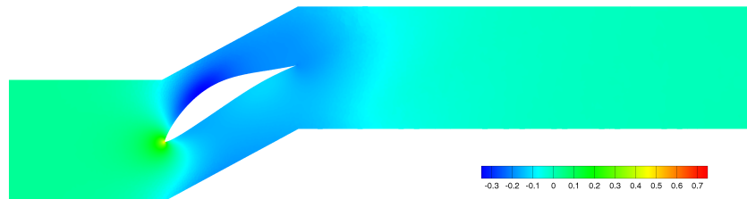
Σχήμα 2.3: Στρωτή ροή σε 2Δ περύγωση συμπίεστη: πεδίο πίεσης στο χώρο ροής της γεωμετρίας της αεροτομής για την οποία επιθυμείται ο υπολογισμός των παραγώγων ευαισθησίας της συνάρτησης απωλειών ολικής πίεσης.
