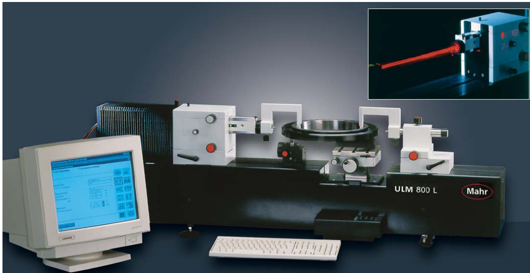
Σχήμα 6.2 : Μηχανή ULM κατά την μέτρηση με επαφή, εξάρτημα μέτρησης με ακτίνες λέιζερ
