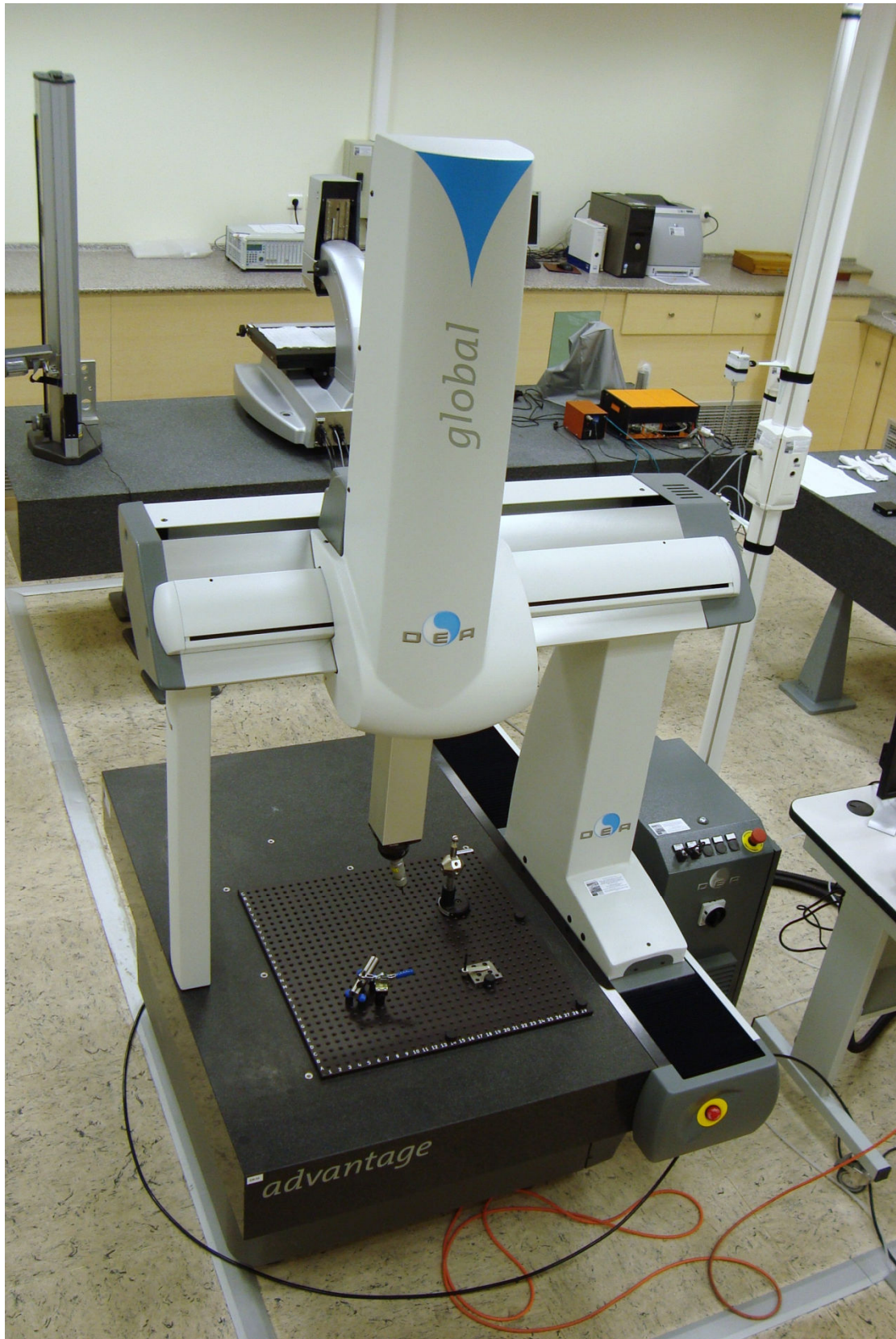
Σχήμα 4.3 : Μηχανή DEA CMM advantage του Μετροτεχνικού Εργαστηρίου ΕΜΠ
