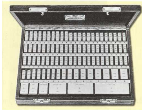
Σχήμα 3.1: Τυπική συλλογή προτύπων πλακιδίων αποτελούμενη από 112 τεμάχια
