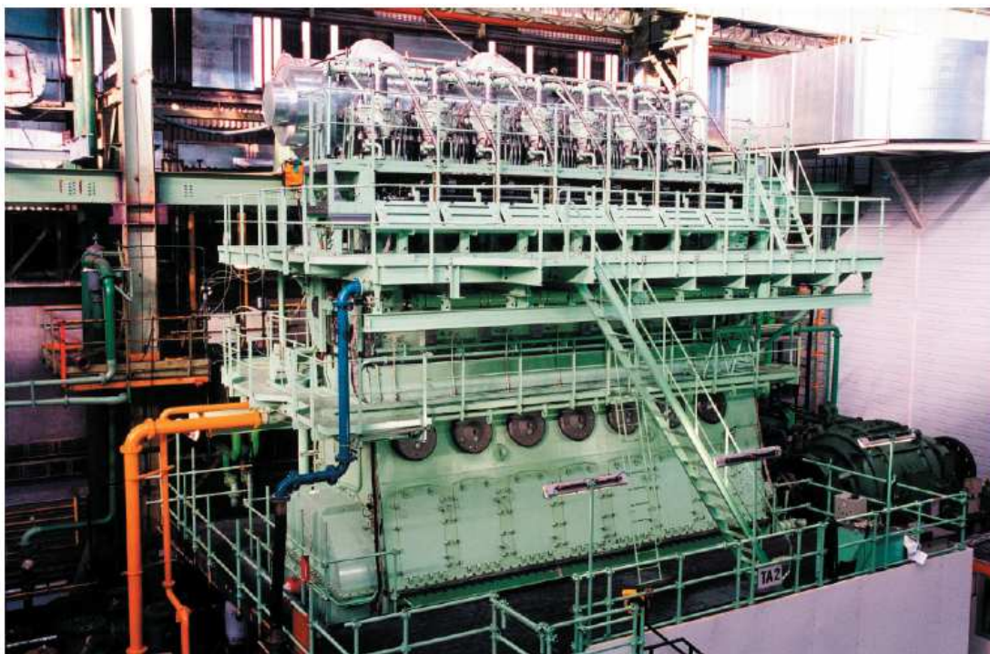
Σχήμα 2-4: Κινητήρας Sulzer 7RT-flex60C με εγκατάσταση συστήματος κοινού συλλέκτη CRS (Wärtsilä Switzerland Ltd, 2004).
