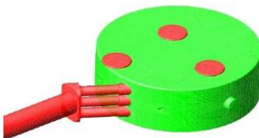
Σχήμα 4-10: Γεωμετρικό μοντέλο υπολογιστικής ρευστοδυναμικής του θαλάμου καύσης σταθερού όγκου, το οποίο περιλαμβάνει τμήμα του αγωγού εισαγωγής (Herrmann et al., 2007).
