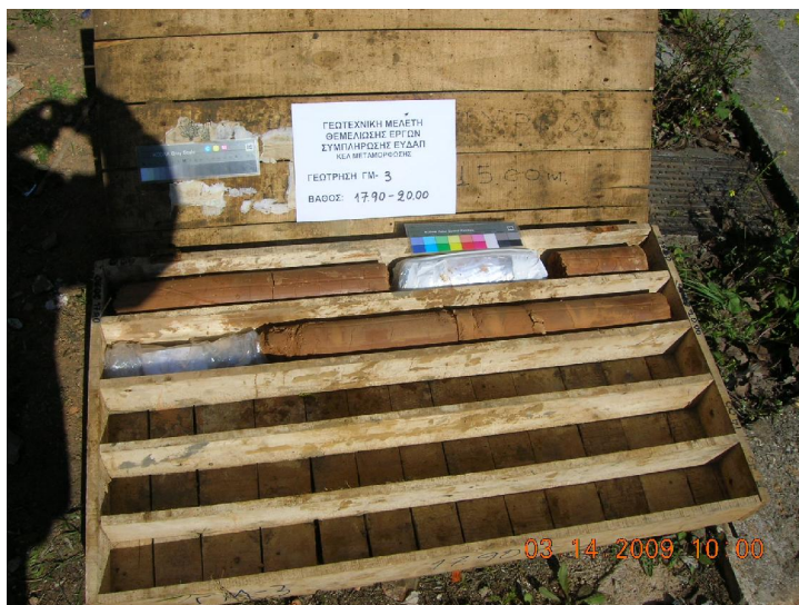
Εικόνα 3.6: Δειγματοληψία γεώτρησης ΓΜ3
