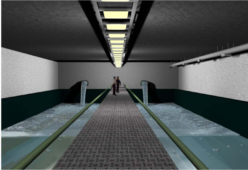
Εικόνα 5.9: Άποψη των δεξαμενών καθίζησης αστικών λυμάτων μετά από την εισαγωγή του Real Flow
