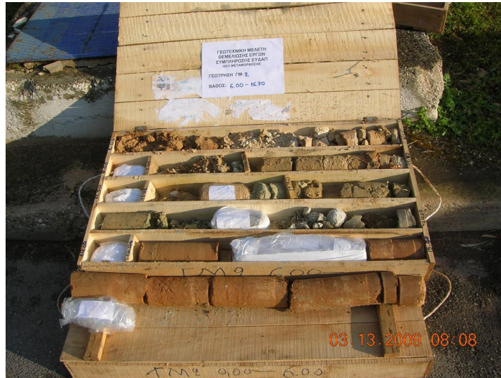
Εικόνα 3.5: Δειγματοληψία γεώτρησης ΓΜ2
