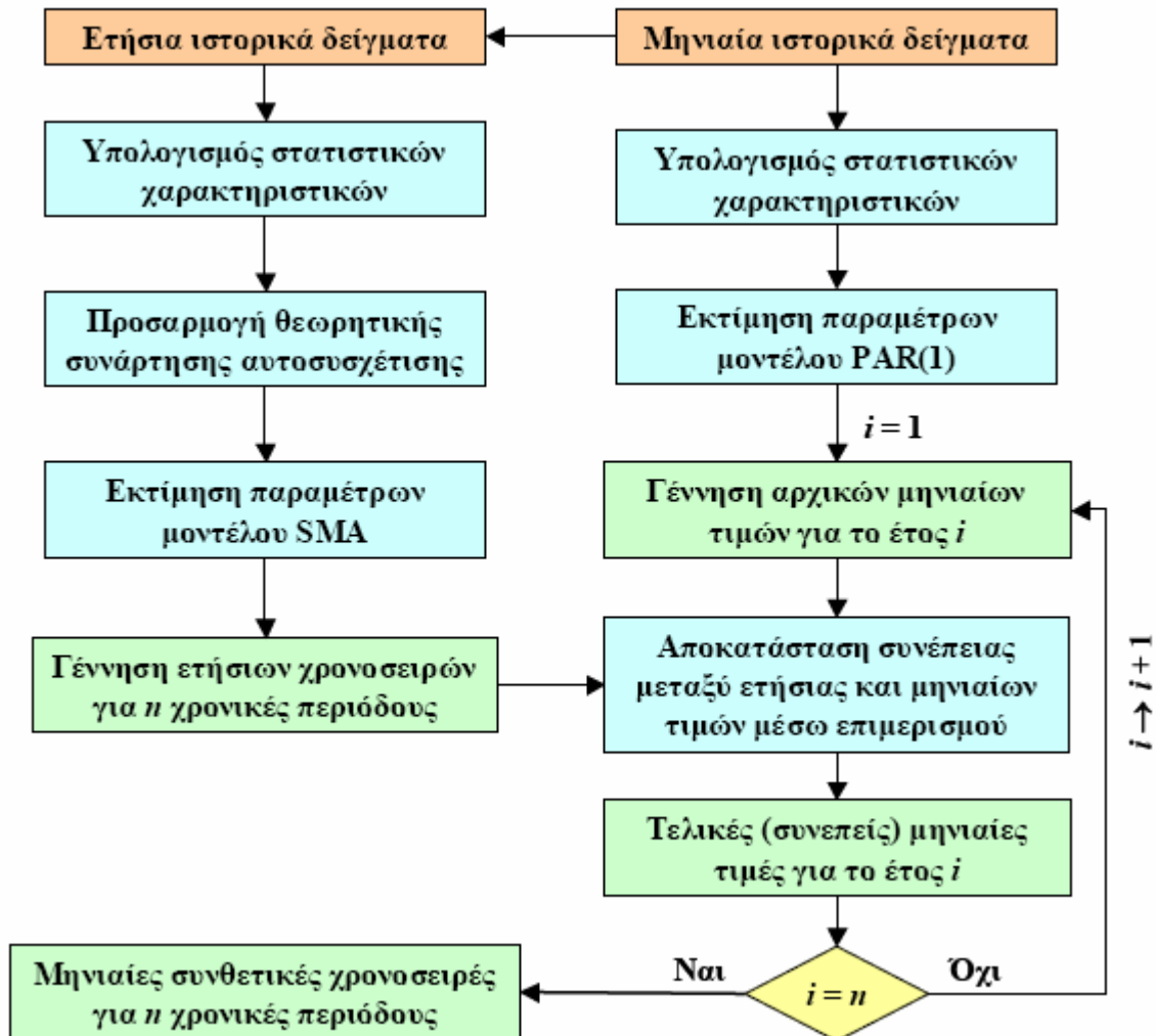
Σχήμα 4.2 : Διάγραμμα ροής σχήματος γέννησης συνθετικών χρονοσειρών για την στοχαστική προσομοίωση συστημάτων υδατικών πόρων σε μηνιαία χρονική κλίμακα, για n συνολικά έτη. (Ευστρατιάδης, 2000).
