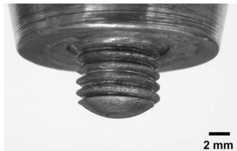
Τυπικό κυλινδρικό εργαλείο με κοίλη πλάτη, σπείρωμα και στρογγυλεμένο άκρο
