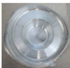
Απώλεια υλικού στη συγκόλληση με τριβή και ανάδευση
