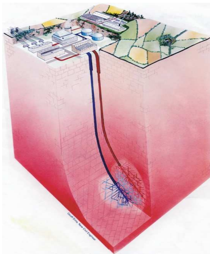
Σχήμα 2.6: Σχηματική αναπαράσταση ενός συστήματος θερμών ξηρών πετρωμάτων [8]
