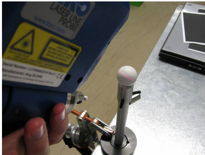
Εικόνα 36: Σάρωση πρότυπης σφαίρας με την λέιζερ κάμερα ΜΜΣ-ΑΒ
