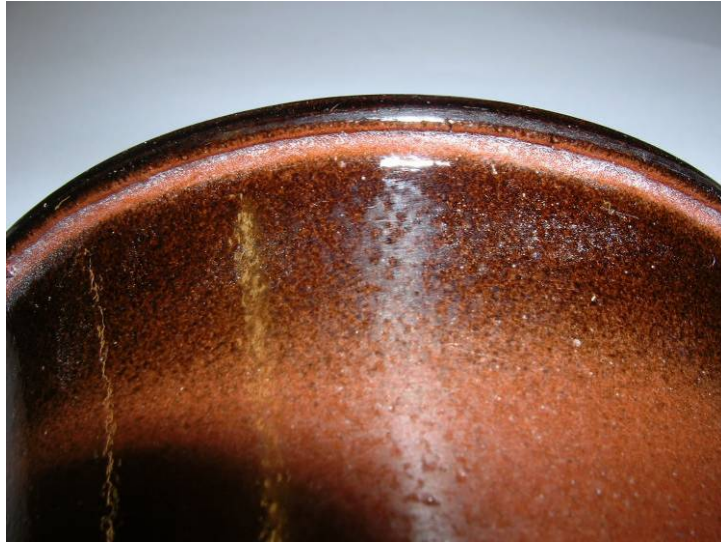
Εικόνα 68: Παράδειγμα επιφάνειας που παρουσιάζει αυξημένη δυσκολία στην σάρωση
