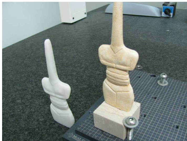
Εικόνα 65 Φάσεις κατασκευής αντιγράφου του ειδωλίου με τη μέθοδο RP/ U-Print
