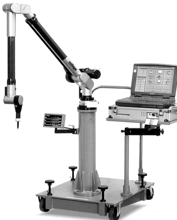
Εικόνα 23 ΜΜΣ τύπου αρθρωτού βραχίονα (ΑΒ) σε τρίποδα
