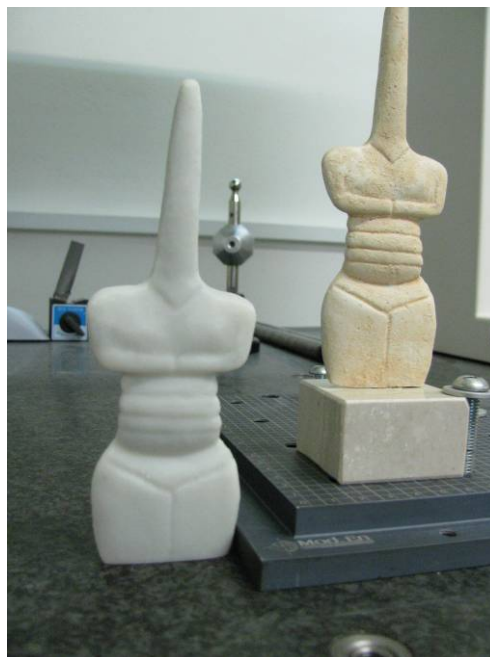
Εικόνα 66 Πρωτότυπο και RP/ U-Print αντίγραφο Κυκλαδικού ειδωλίου
