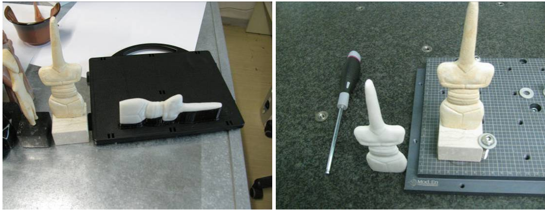
Εικόνα 65 Φάσεις κατασκευής αντιγράφου του ειδωλίου με τη μέθοδο RP/ U-Print
