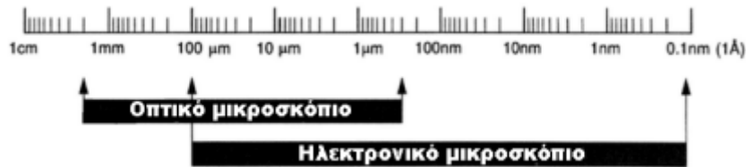
Εικόνα 1.1. Σύγκριση διακριτικής ικανότητας οπτικών και ηλεκτρονικών μικροσκοπίων
