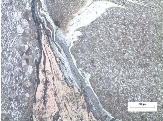
Εικόνα 6.2.26 : Μικρογραφία δοκιμίου 3,2, όπου απεικονίζεται η ροή του χαλκού και του αλουμινίου.
