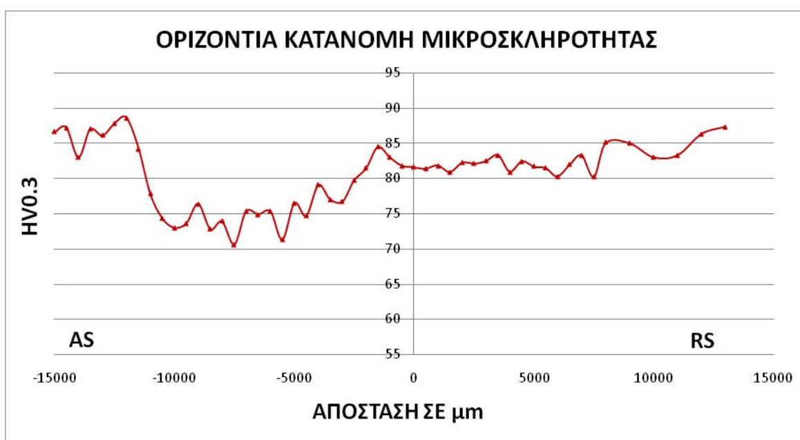
Σχήμα 6.1.2.1: Σκληρότητα σε HV0.3 οριζόντια της συγκόλλησης, όπου AS προωθούμενη πλευρά και RS υποχωρούσα πλευρά.
