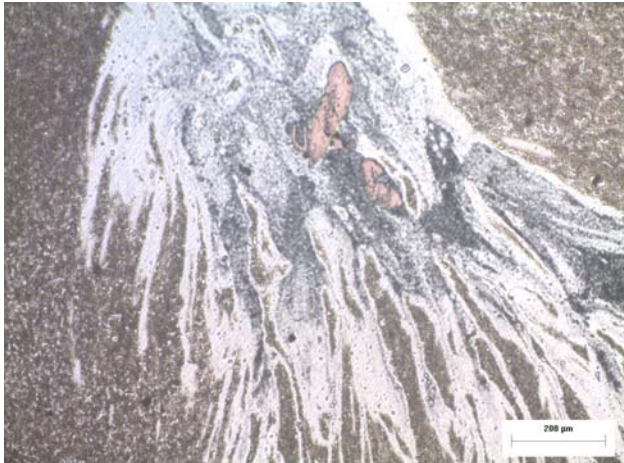
Εικόνα 6.2.54 : Μικρογραφία δοκιμίου 1, όπου απεικονίζεται η ροή του αλουμινίου με σωματίδια χαλκού.
