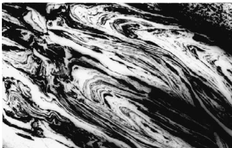
Εικόνα 4.1 : αλουμίνιο στο οποίο έχει τοποθετηθεί χαλκός για να εξεταστεί η ροή του υλικού κατά τη FSW. Οι φωτεινές περιοχές είναι χαλκός, ενώ οι σκούρες το αλουμίνιο. [10]
