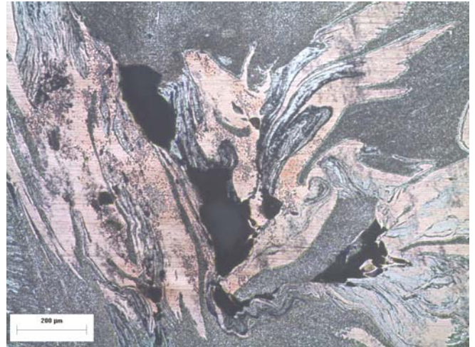
Εικόνα 6.2.15 : Μικρογραφία δοκιμίου 1 όπου απεικονίζεται η ροή του χαλκού που συνιστά μια χαοτική δυναμική ανάμειξη.
