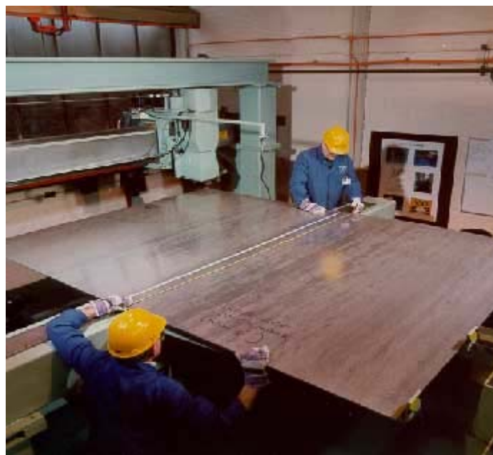
Εικόνα 2.7 : Συγκόλληση ελασμάτων πλοίου με τη χρήση της μεθόδου FSW. [2]
