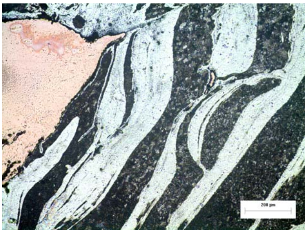
Εικόνα 6.2.64 : Μικρογραφία δοκιμίου 3,1 όπου απεικονίζεται η ροή του χαλκού και του αλουμινίου.
