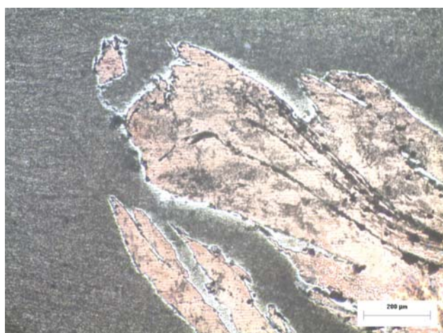
Εικόνα 6.2.33 : Μικρογραφία δοκιμίου 2,1, όπου απεικονίζεται η ροή του χαλκού με κενά που αναπληρώνονται από το αλουμίνιο.
