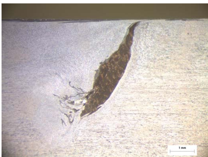
Εικόνα 6.2.86 :Μακρογραφία του δοκιμίου (α) χωρίς κλίση εργαλείου συγκόλλησης και ταχύτητα περιστροφής 475 RPM και μακρογραφία δοκιμίου (β) με κλίση εργαλείου συγκόλλησης 2° και ταχύτητα περιστροφής 600 RPM.
