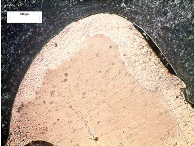
Εικόνα 6.2.76 : Μικρογραφία δοκιμίου 5, όπου απεικονίζεται η ροή του χαλκού.
