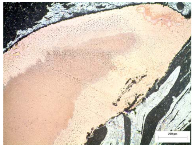
Εικόνα 6.2.65 : Μικρογραφία δοκιμίου 3,1 όπου απεικονίζεται η ροή του χαλκού και του αλουμινίου.
