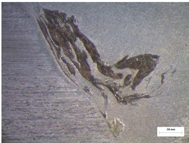
Εικόνα 6.3.3.85 :Μακρογραφία του δοκιμίου (α) χωρίς κλίση εργαλείου συγκόλλησης και ταχύτητα περιστροφής 475 RPM και μακρογραφία δοκιμίου (β) με κλίση εργαλείου συγκόλλησης 2° και ταχύτητα περιστροφής 600 RPM .
