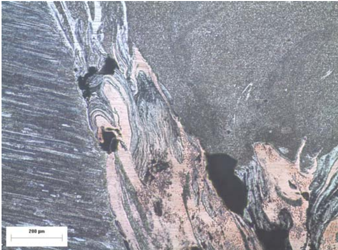
Εικόνα 6.2.14 : Μικρογραφία δοκιμίου 1, όπου απεικονίζεται η ροή του χαλκού καθώς και η μετάβαση από τη ΖΑ στην ΤΜΑΖ της προωθούμενης πλευράς.
