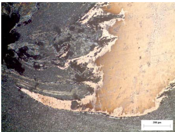
Εικόνα 6.2.36 : Μικρογραφία δοκιμίου 2,2, όπου απεικονίζεται η ροή του χαλκού και ελαττώματα της συγκόλλησης.
