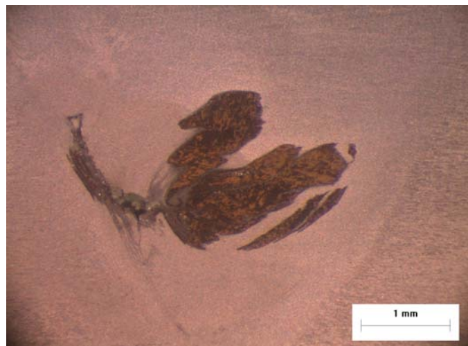
Εικόνα 6.3.3.85 :Μακρογραφία του δοκιμίου (α) χωρίς κλίση εργαλείου συγκόλλησης και ταχύτητα περιστροφής 475 RPM και μακρογραφία δοκιμίου (β) με κλίση εργαλείου συγκόλλησης 2° και ταχύτητα περιστροφής 600 RPM .
