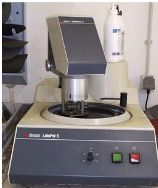
Εικόνα 5.5 : Εξοπλισμός λείανσης-στίλβωσης (Struers LaboPol-5) των δοκιμίων στο Εργαστήριο Ναυπηγικής Τεχνολογίας της Σχολής Ναυπηγών Μηχανολόγων Μηχανικών του ΕΜΠ.
