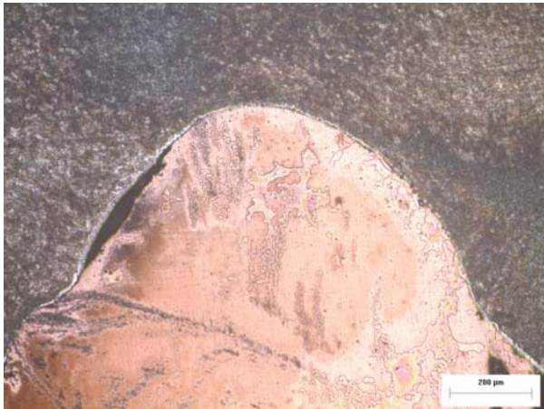
Εικόνα 6.2.73 : Μικρογραφία δοκιμίου 4,2, όπου απεικονίζεται η ροή του χαλκού.
