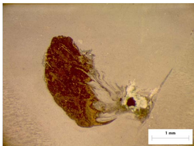
Εικόνα 6.2.86 :Μακρογραφία του δοκιμίου (α) χωρίς κλίση εργαλείου συγκόλλησης και ταχύτητα περιστροφής 475 RPM και μακρογραφία δοκιμίου (β) με κλίση εργαλείου συγκόλλησης 2° και ταχύτητα περιστροφής 600 RPM.
