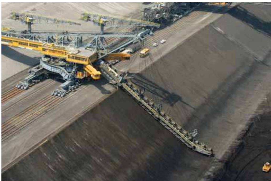
Εικόνα 4.3.3: Βαθμίδα με Bucket Chain Excavator
