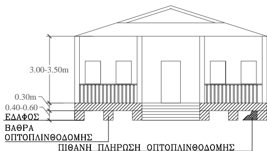
Εικόνα 11-6. Τυπική ισόγεια κατοικία, υπερυψωμένη ελάχιστα λόγω ημιυπογειου χώρου, σύγχρονης εποχής,
