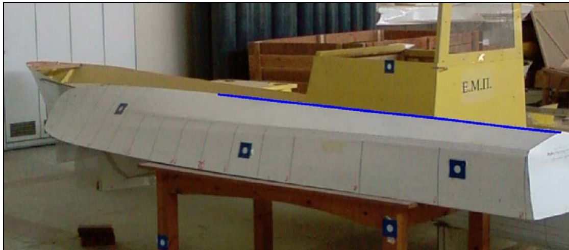
Εικόνα 4.5 : Περιοχή με μεγαλύτερες πιθανότητες σφάλματος στην καρίνα του σκάφους(μπλε γραμμοσκίαση).
