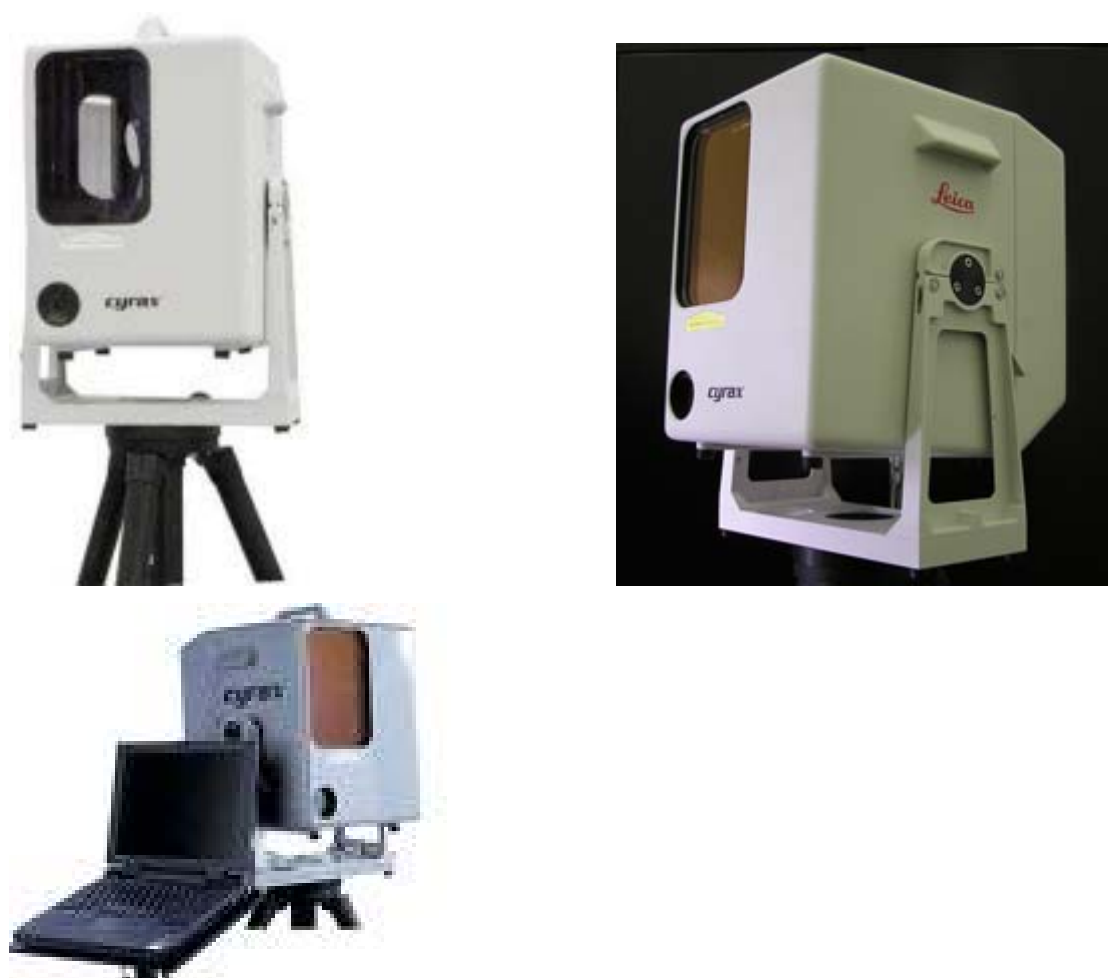
Εικόνα 3.6 :Laser Scanner Leica HDS 2500 και παρελκόμενα. [www.leica-geosystems.com]
