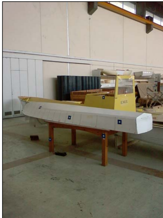
Εικόνα 4.2: Τελική θέση μοντέλου. Πρώτη θέση για μέτρηση με Laser Scanner.
