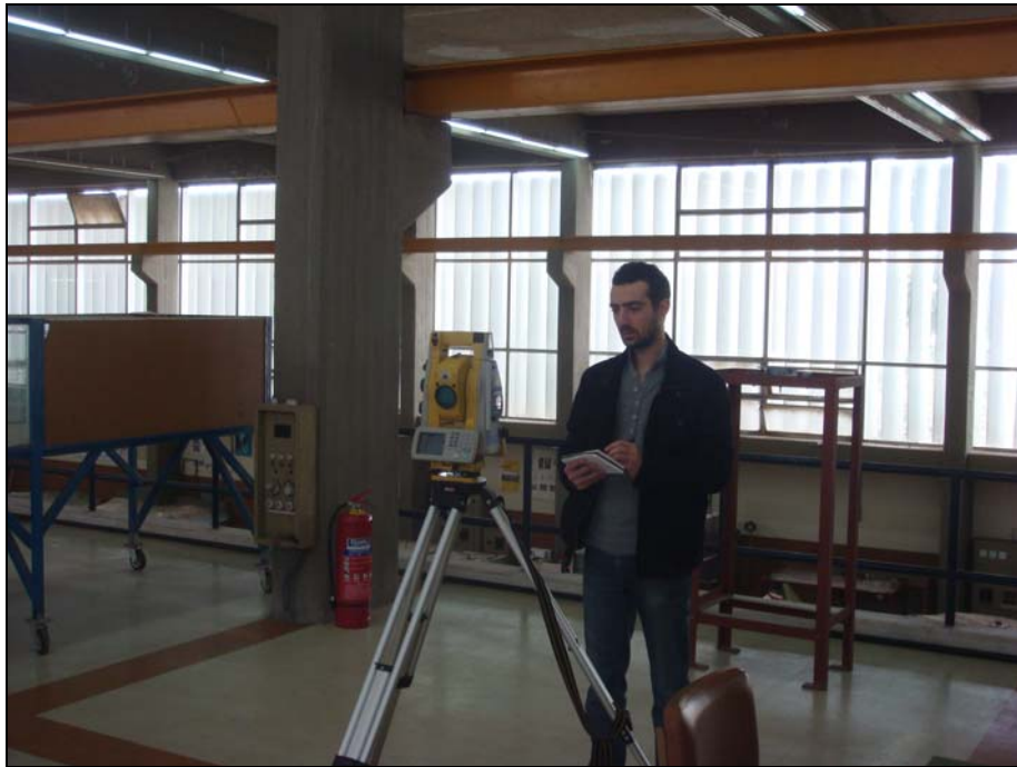
Εικόνα 4.7 : Διαδικασία μέτρησης με Topcon IS.
