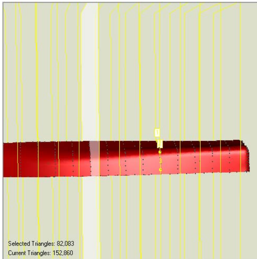
Εικόνα 5.27 : Διαδικασία χάραξης νομέων με την εντολή «Cross Section» [Geomagic 9]
