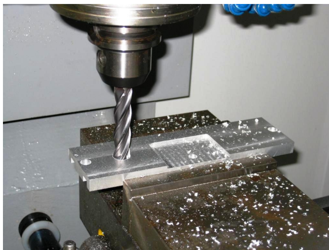
εικόνα 5.6: δημιουργία δύο μεγάλων οπών για να επιτύχουμε το ελάχιστο δυνατό βάρος.
