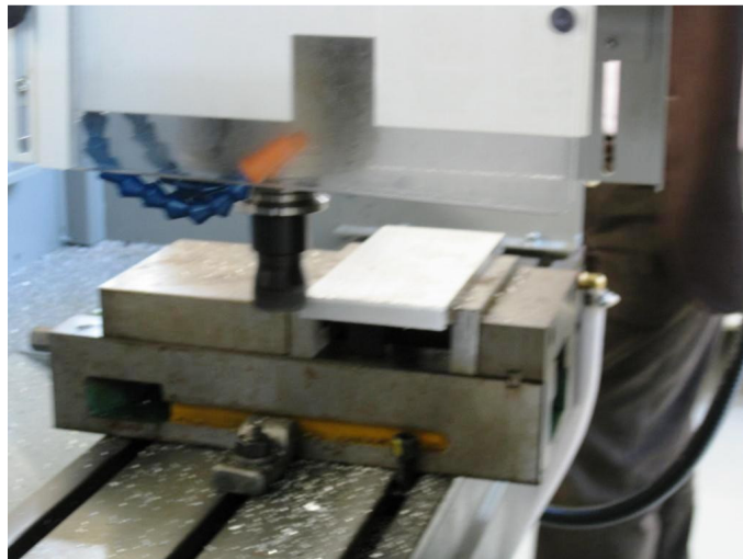
εικόνα 5.3: συγκράτηση του τεμαχίου από αλουμίνιο – πρώτο στάδιο κατεργασίας.
