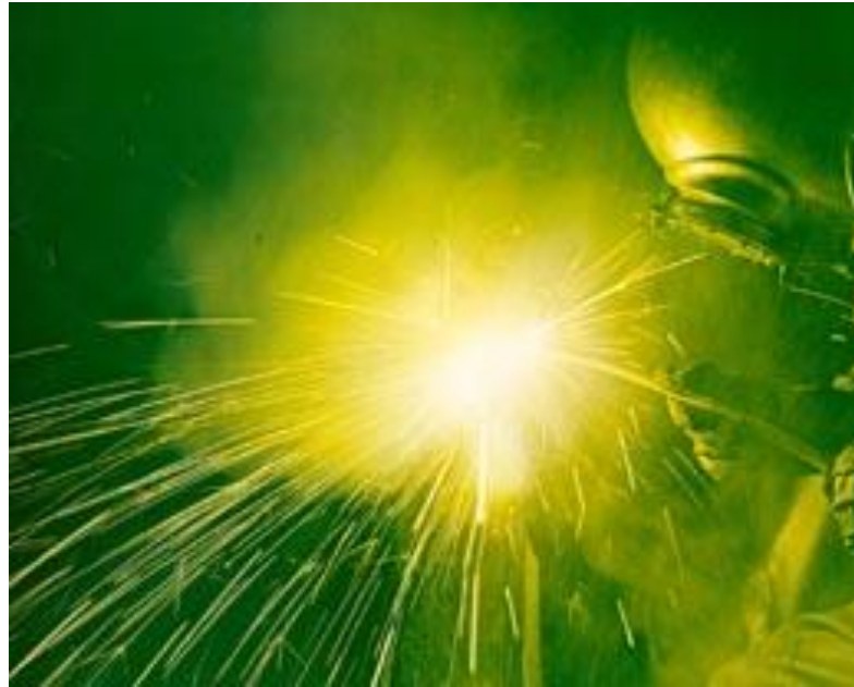
Φωτογραφία 3.6: Υποβρύχια κοπή με θερμικό καλώδιο
