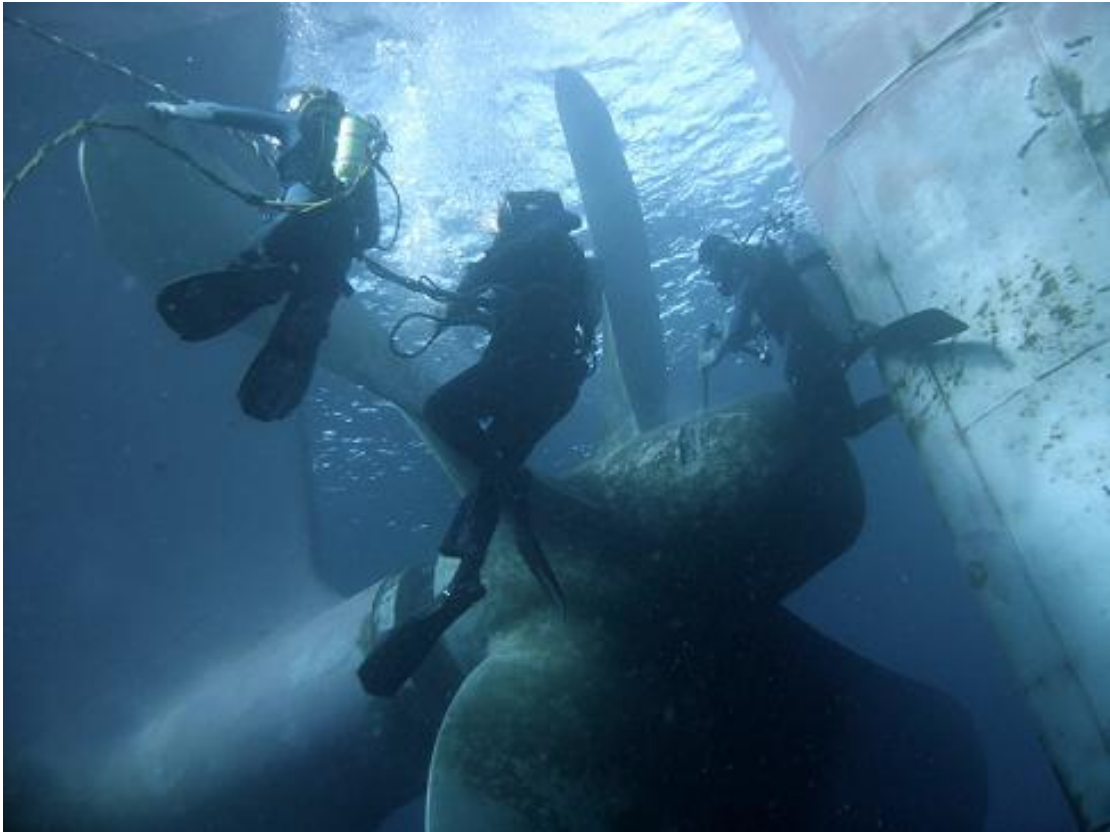
Φωτογραφία 1.7: Υποβρύχιες εργασίες καθαρισμού γάστρας και προπέλας πλοίου
