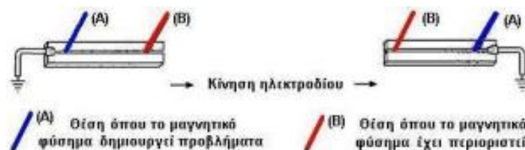
Φωτογραφία 2.13: Αντιμετώπιση του φύσηματος με αλλαγή του σημείου γείωσης
