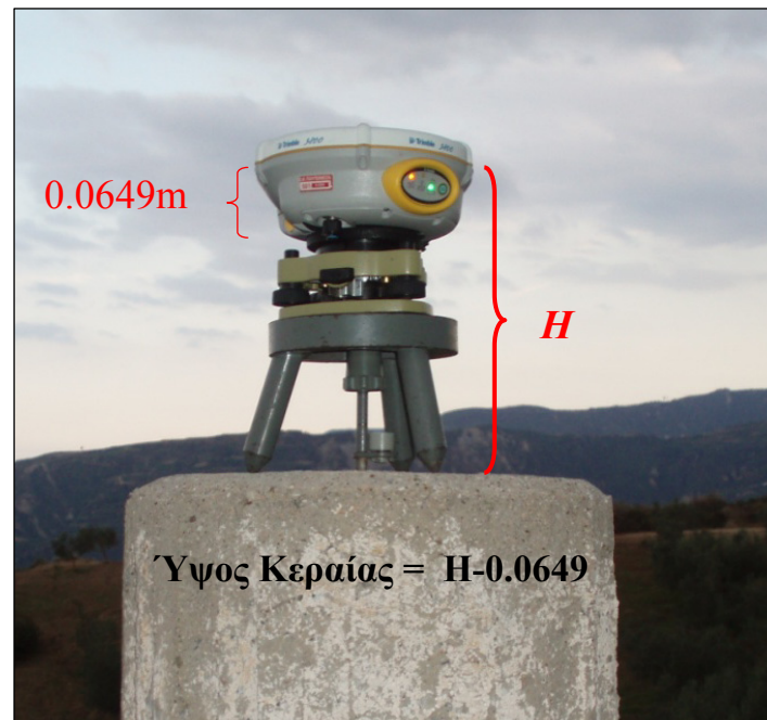
Εικόνα 2.8: Μέτρηση ύψους κεραίας.
