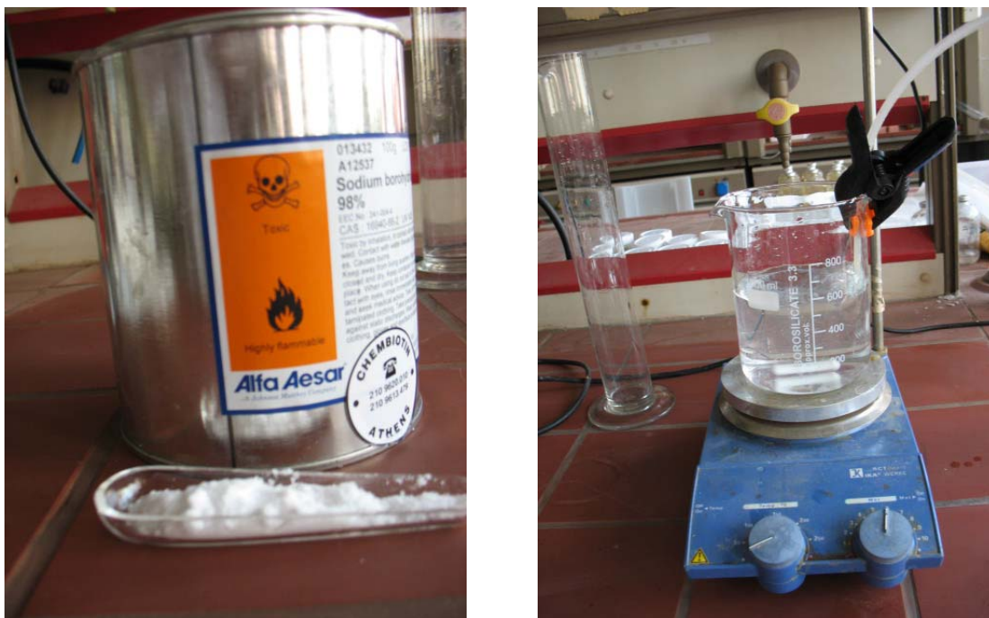
Εικόνα 6.2. \text{NaBH}_4 (αριστερά) και διαδικασία διαλυτοποίησης του \text{NaBH}_4 με μαγνητική ανάδευση και εμφύσηση αέριου \text{N}_2 (δεξιά)
