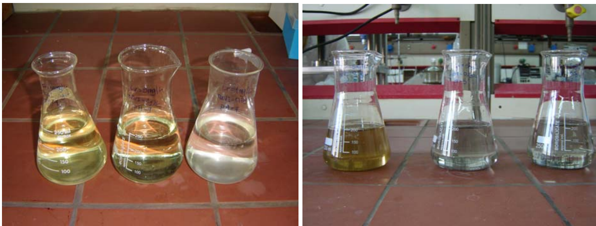
Εικόνα 6.5. Αριστερά διαλύματα χρωμίου, δεξιά διαλύματα χρωμίου που αντέδρασαν με νανοσίδηρο για 2 ώρες.
