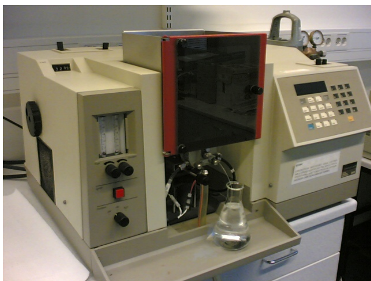
Εικόνα 6.13. Συσκευή Ανάλυσης AAS
