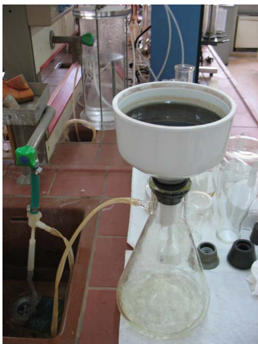
Εικόνα 6.1. Διήθηση υπό κενό για την ανάκτηση του νανοσιδήρου (αριστερά) και μεμβράνη διήθησης 0,2μm με νανοσίδηρο (δεξιά)
