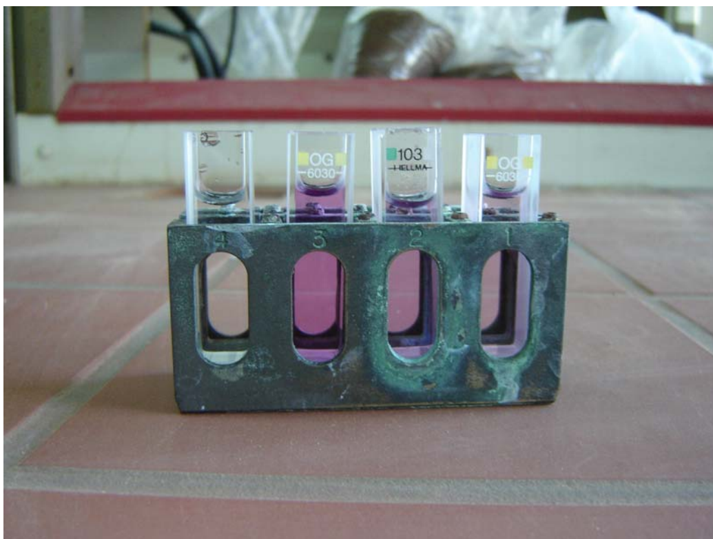
Εικόνα 6.12. Κυψέλες 1cm με διαλύματα Cr
