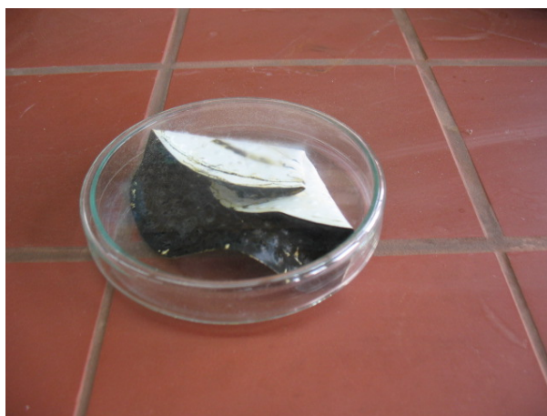
Εικόνα 6.1. Διήθηση υπό κενό για την ανάκτηση του νανοσιδήρου (αριστερά) και μεμβράνη διήθησης 0,2μm με νανοσίδηρο (δεξιά)
