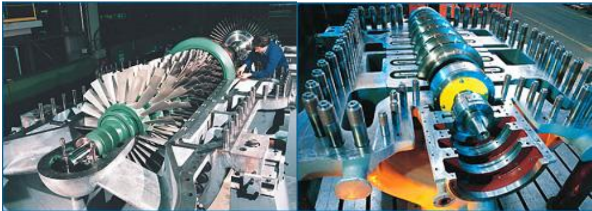
Σχήμα 2.6. Αξονικός συμπιεστής τμήματος χαμηλής πίεσης (αριστερά) και ακτινικός συμπιεστής τμημάτων μέσης και υψηλής πίεσης (δεξιά) [8]
