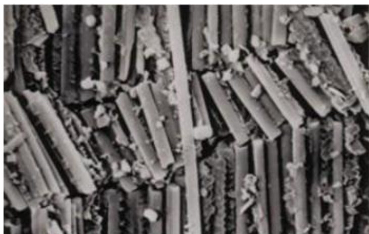
Σχήμα 5.1.2- Θραύση σε ακανόνιστα σχήματα
