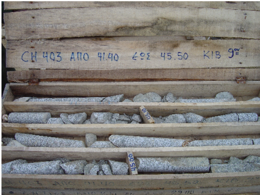
Εικόνα 4.1. Πυρήνες δειγματοληπτικής γεώτρησης από το γνευσιακό υπόβαθρο
