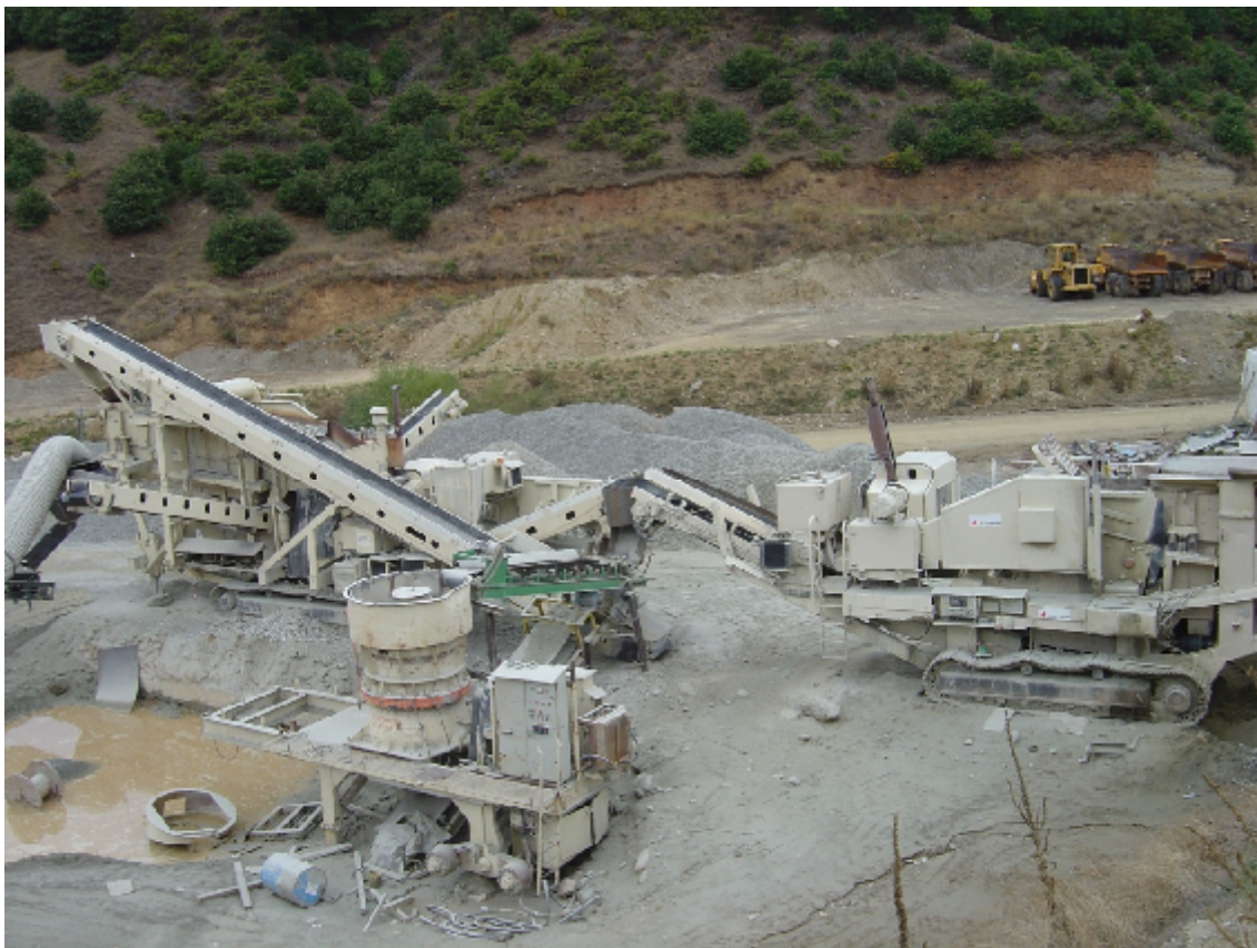
Εικόνα 5.17. Σπαστήρας διπλής επεξεργασίας με πλυντήριο τύπου μύλου
