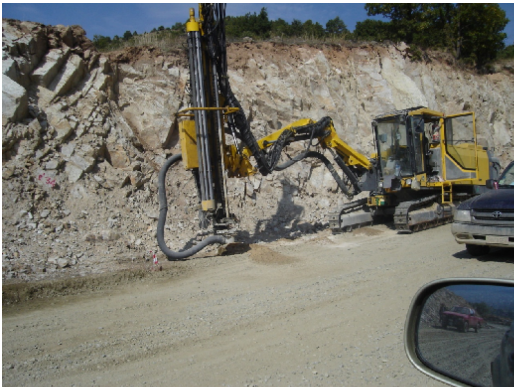
Εικόνα 4.2. Κρουστικός εξοπλισμός, Wagon-drill
