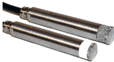
Εικόνα 6.2. Ηλεκτρικά πιεζόμετρα (Διαδικτυακός τόπος http://www.soil.co.uk/.../heavy-duty-vibrating-wire-piezometer )
