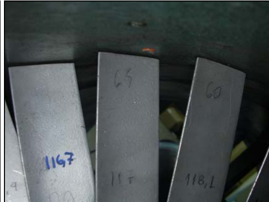
Σχήμα 2.33: Ο δίσκος με τα περύγια τοποθετημένος μέσα στη διάταξη. Διακρίνεται το ακτινικό διάκενο.
