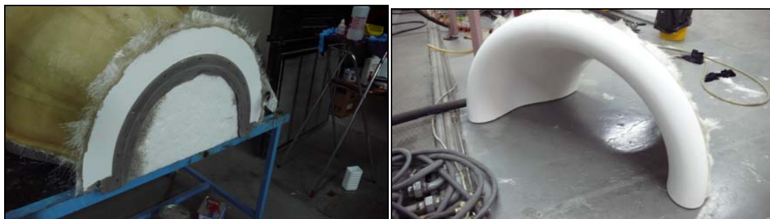
Σχήμα Π4.9: Αποκόλληση (ξεκαλούπωμα) του αντικειμένου (μισό bellmouth).
