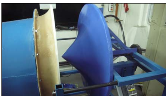
Σχήμα 2.24: Πλάγια όψη τοποθετημένου χείλους εξόδου .
