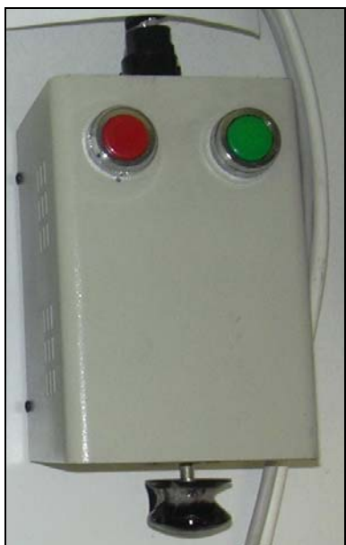
Σχήμα 2.44: Χειριστήριο ελέγχου DC κινητήρα δεύτερης πτερωτής.
