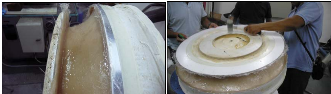
Σχήμα Π4.17: Αριστερά : Μετά τις τρεις στρώσεις υαλοπλήματος. Δεξιά : Η προσπάθεια ξεκαλούπωματος του αντικειμένου με χρήση ματσόλας στο ξύλινο δακτύλιο.
