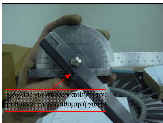
Σχήμα 2.37: Ρύθμιση του ρυθμιστή γωνίας stagger στην επιθυμητή γωνία .
