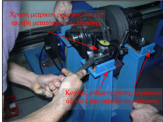
Σχήμα Π1.14: Ρύθμιση της εδράσεως ΕΔΡ1Α στο επίπεδο της κίτοψης, κατά την διαδικασία ευθυγράμμισης.
