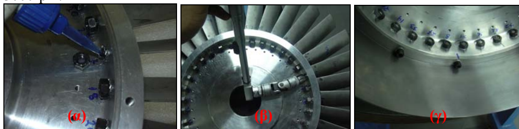
Σχήμα Π1.46: α) Προσθήκη ασφαλιστικής κόλλας LocTight στα σπειρώματα, β) Σύσφιξη με ροπόκλειδο, γ) Χρήση γκρόβερ DIN 127B στους κοχλίες του αποστάτη των πτερωτών.
