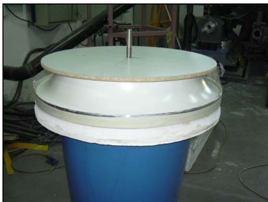
Σχήμα 2.22: Καλούπι του χείλους εξόδου από εποξειδική ρητίνη, πολυεστερικό στόκο, φελιζόλ και μελαμίνη .
