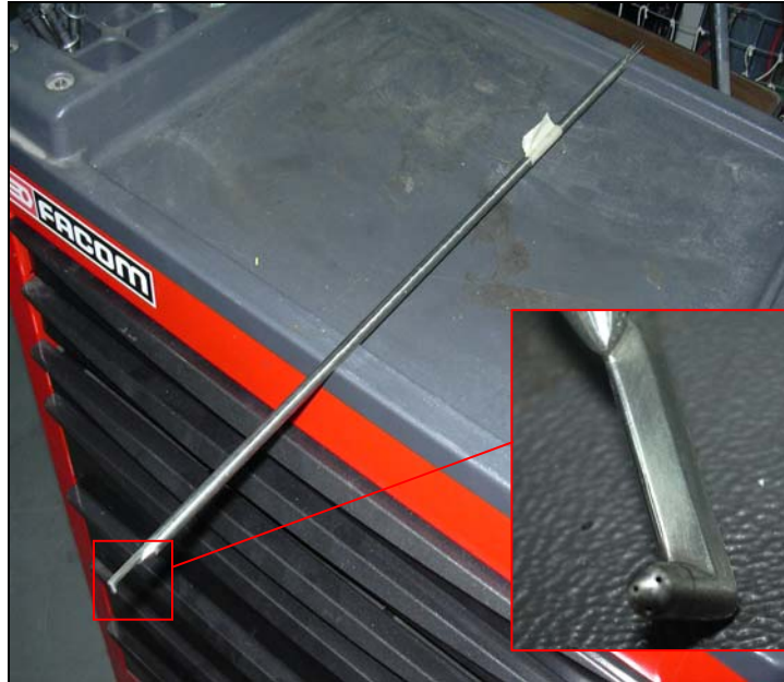
Σχήμα 3.6: Σωλήνας πίεσης πέντε οπών (5-hole Probe) της διάταξης .
