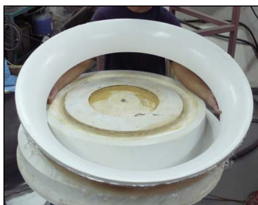
Σχήμα 2.23: Χείλος εξόδου από πολυεστέρα (ρητίνη) και υαλούφασμα .
