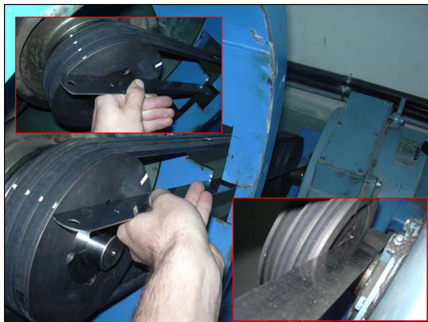
Σχήμα Π1.21: Ευθυγράμμιση των τροχαλιών με χρήση της μεταλλικής ρίγας.
