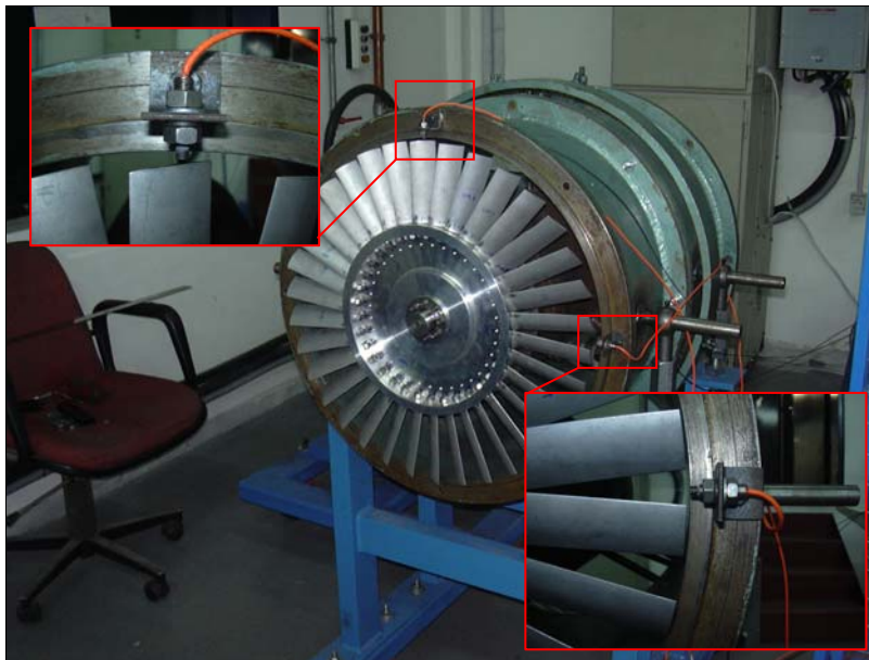
Σχήμα Π1.49: Αισθητήρες προσέγγισης – απόστασης για μέτρηση οριζόντιας και κατακόρυφης ταλάντωσης πτερυγίων.
