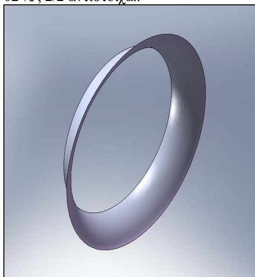
Σχήμα 2.18: Σχέδιο CAD της εσωτερικής επιφάνειας του χείλους εξόδου.
