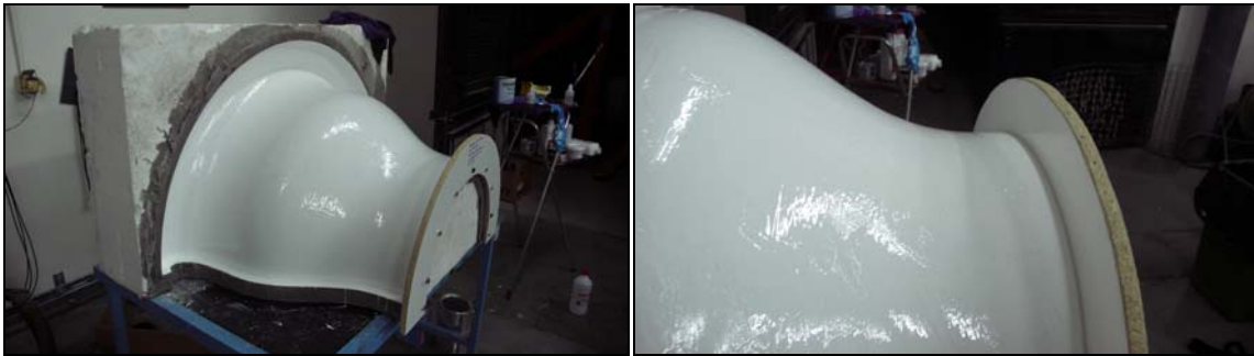
Σχήμα Π4.5: Το καλούπι περασμένο με gelcoat.
