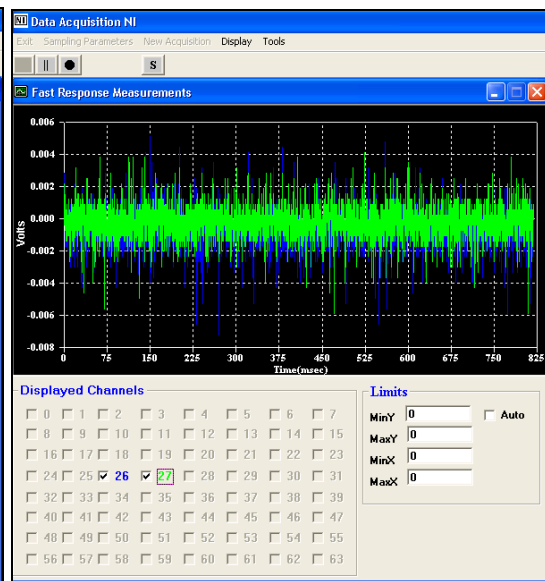
Σχήμα 3.43: Παράθυρο εμφάνισης της χρονοσειράς του σήματος των καναλιών του ADC (Fast Response Measurements).
