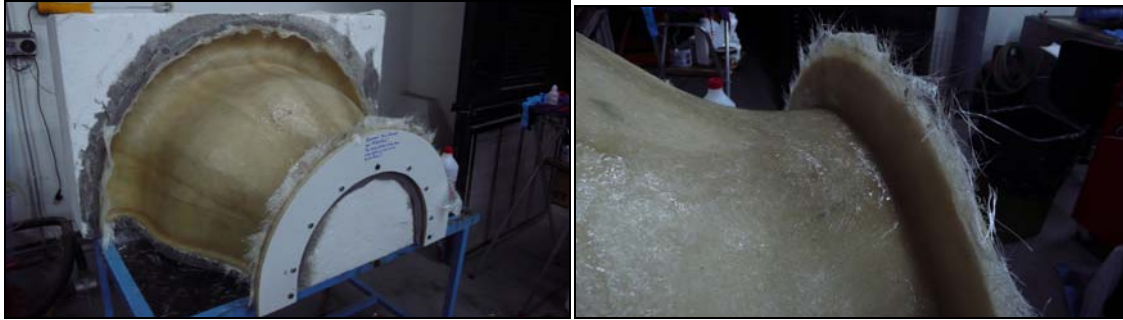
Σχήμα Π4.8: Στρώσεις υαλοπίληματος στο bellmouth.
