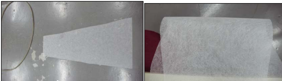
Σχήμα Π4.6: Ύφασμα ινών γυαλιού τύπου "αράχνη".
