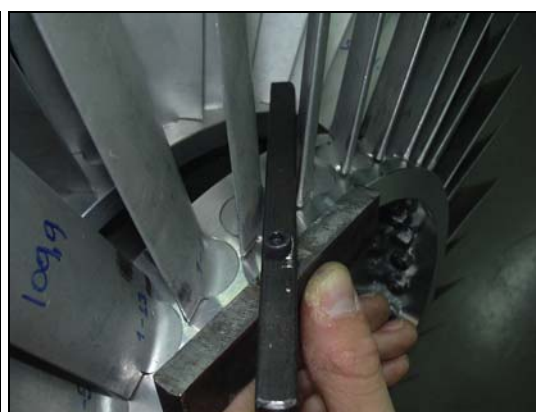
Σχήμα 2.38: Ο ρυθμιστής γωνίας stagger επί τω έργω.
