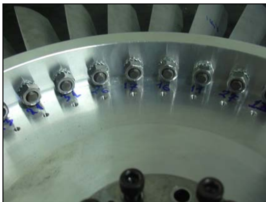
Σχήμα 2.39: Οι θέσεις των αριθμημένων πτερυγίων σε ταξινόμηση ανάλογα με το βάρος τους .
