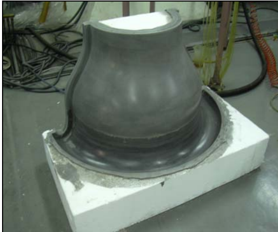
Σχήμα 2.9: Καλούπι του μισού αγωγού εισόδου από εποξειδική ρητίνη και φελιζόλ.
