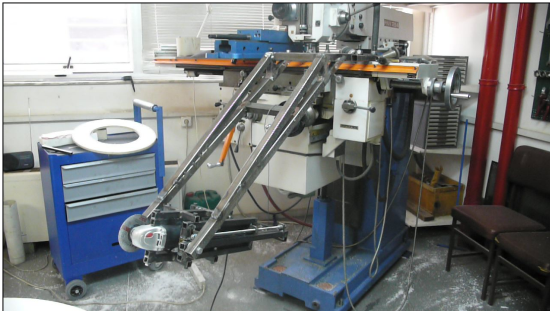
Σχήμα 2.27: Βραχίονας κοπής τοποθετημένος στην τράπεζα της φρέζας.
