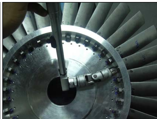
Σχήμα 2.40: Σύσφιξη των πτερυγίων στους δίσκους με χρήση ροπόκλειδου.
