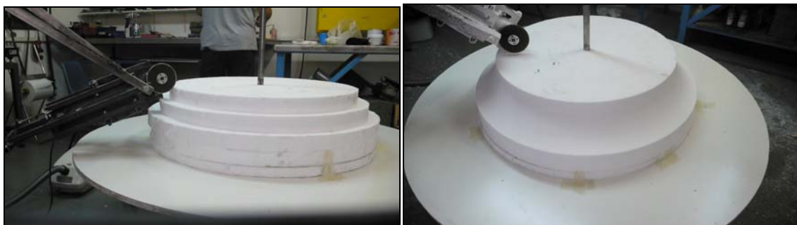
Σχήμα Π4.11: Το καλούπι στο πρώιμο στάδιο. Αριστερά : Οι δίσκοι φελιζόλ πριν τη διαμόρφωση. Δεξιά : Μετά τη διαμόρφωση του κυκλικού τόξου στο καλούπι με τη χρήση του βραχίονα διαμόρφωσης φελιζόλ.
