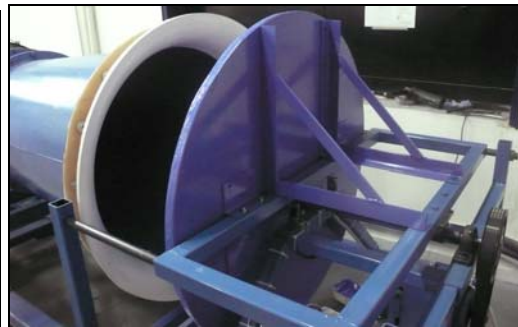
Σχήμα 2.25: Προοπτική όψη τοποθετημένου χείλους εξόδου .
