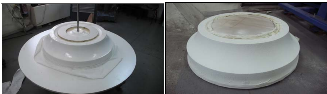
Σχήμα Π4.13: Αριστερά : Πέρασμα με πινέλο της εποξειδικής ρητίνης στο καλούπι για την προστασία του φελιζόλ από τον πολυεστέρα. Δεξιά : το καλούπι μετά τα τρία χέρια βαφής του με πολυεστερικό στόκο πιστολιού .
