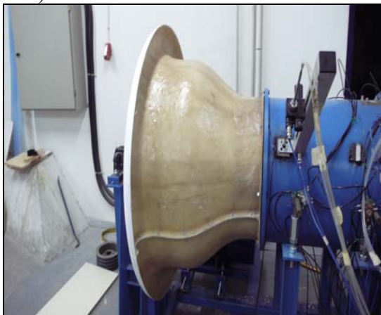
Σχήμα 2.11: Πλάγια όψη τοποθετημένου αγωγού εισόδου.
