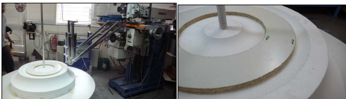
Σχήμα Π4.12: Η διαμόρφωση στο καλούπι για την υποδοχή του ξύλινου δακτυλίου συγκράτησης της φλάντζας του καλουπιού.
