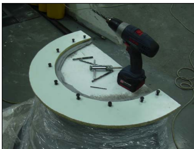
Σχήμα Π4.3: Ξύλινη φλάντζα καλουπιού αγωγού εισόδου.
