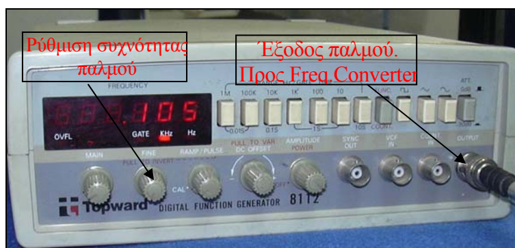
Σχήμα 3.24: Παλμογεννήτρια για τη βαθμονόμηση μετατροπέων συχνότητας.
