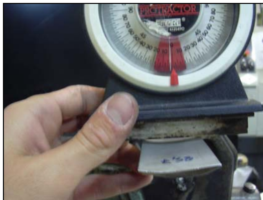
Σχήμα 2.36: Μέτρηση της γωνίας κλίσης σε διάφορες θέσεις του εκπετάσματος, για εύρεση της γωνίας συστροφής (twist angle).
