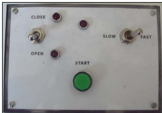
Σχήμα 2.46: Χειριστήριο ελέγχου AC 3Φ κινητήρα διάταξης στραγγαλισμού παροχής.
