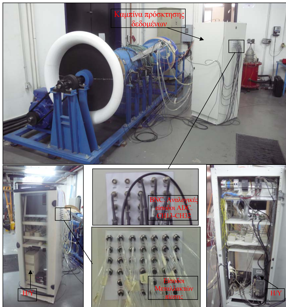
Σχήμα 3.40: Καμπίνα πρόσκτησης δεδομένων μετρήσεων εγκατάστασης.
