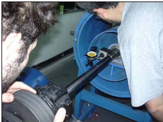
Σχήμα Π1.16: Μέτρηση της απόκλισης του 1 ου άξονα με το 1 ο μετρητικό ρολόι στην θέση MET1.
