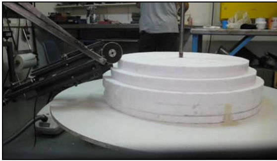
Σχήμα 2.29: Διάταξη διαμόρφωσης φελιζόλ. Διακρίνεται ο βραχίονας καθώς και οι δίσκοι φελιζόλ πριν τη διαμόρφωση, επάνω στον κατακόρυφο τόρνο.
