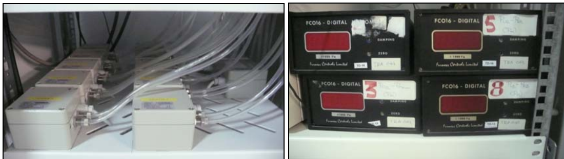
Σχήμα 3.13: Μεταλλάκτες πίεσης (Pressure Transducers) της διάταξης. Αριστερά : Μεταλλάκτες για μέτρηση των πιέσεων από τις οπές των σωλήνων πίεσης. Δεξιά : Μεταλλάκτες για μέτρηση των στατικών πιέσεων στο κέλυφος του συμπιεστή.
