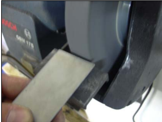
Σχήμα 2.32: Τροχίσμα των περυγίων για δημιουργία του κυκλικού τόξου στο TTP.
