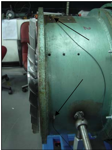
Σχήμα Π1.47: Επιταχυνσιόμετρα για μέτρηση κατακόρυφου και οριζόντιου κραδασμού.
