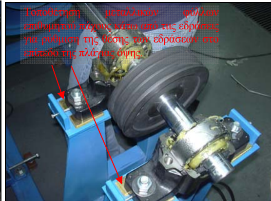
Σχήμα Π1.15: Ρύθμιση των εδράσεων ΕΔΡ1Α και ΕΔΡ1Β στο επίπεδο της πλάγιας όψης, κατά την διαδικασία ευθυγράμμισης.
