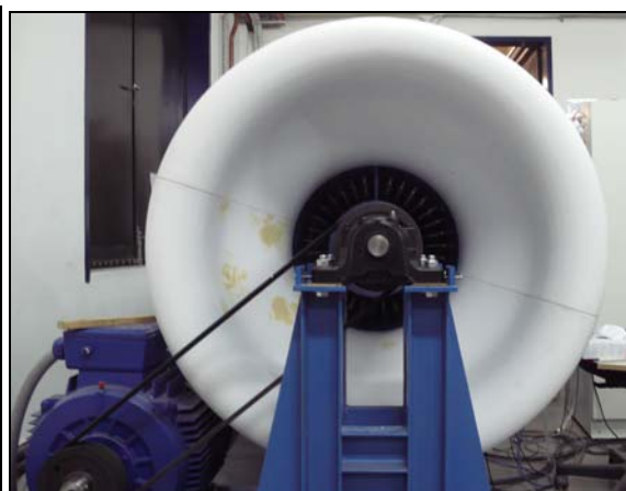
Σχήμα 2.12: Πρόσωση τοποθετημένου αγωγού εισόδου.
