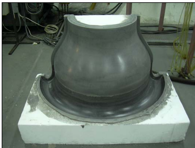
Σχήμα Π4.4: Το καλούπι κερωμένο και έτοιμο για χρήση.
