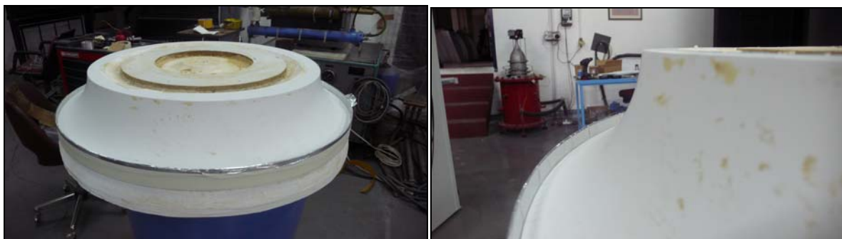
Σχήμα Π4.14: Το καλούπι μετά το τρίψιμο του πολυεστερικού στόκου και του στοκαρίσματος. Έχει περαστεί και η φλάντζα περιμετρικά που αποτελείται από λωρίδα πλεξιγκλάς και αλουμινοταινία.
