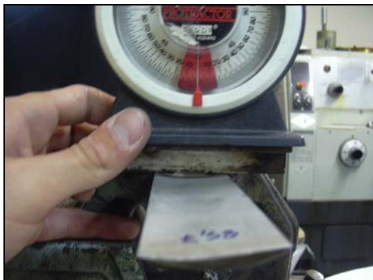
Σχήμα 2.35: Ρύθμιση της γωνίας κλίσης του περύγιου στο Hub στις 0^\circ με χρήση βαρυντικού μοιρογνωμονίου.
