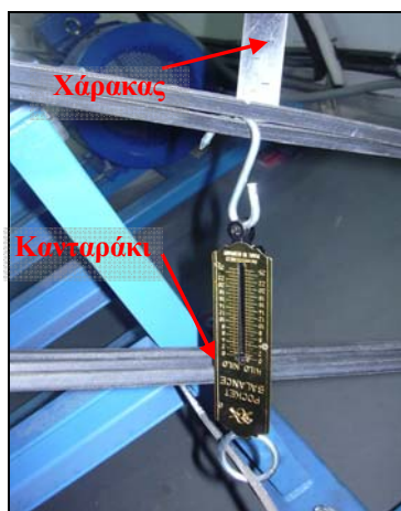
Σχήμα Π1.26: Τάνυση μάντων κίνησης στη διάταξη.
