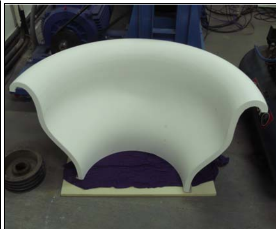
Σχήμα 2.10: Μισός αγωγός εισόδου από πολυεστέρα (ρητίνη) και υαλούφασμα.
