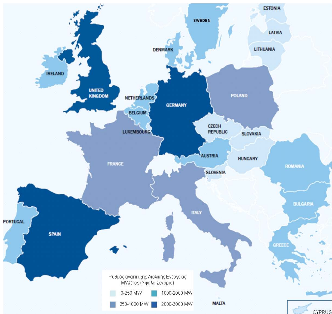
Σχήμα 2.16: Ετήσιος ρυθμός ανάπτυξης της αιολικής ενέργειας (MW/έτος) μέχρι το 2020 στις χώρες της ΕΕ σύμφωνα με το «υψηλό» σενάριο της EWEA [Πηγή: EWEA, 2009]
